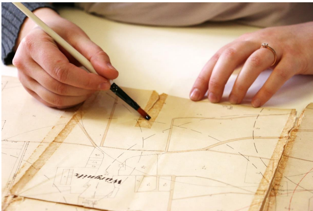
Obr. 10 Proces restaurování, ztenčování reziduí adhezivních pásek (aplikace gelu 3% Klucelu E v acetonu)
