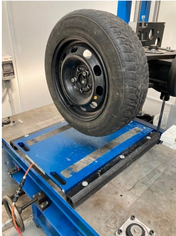
Obr. 31: Zkoušené kolo a platforma nájezdových vah
