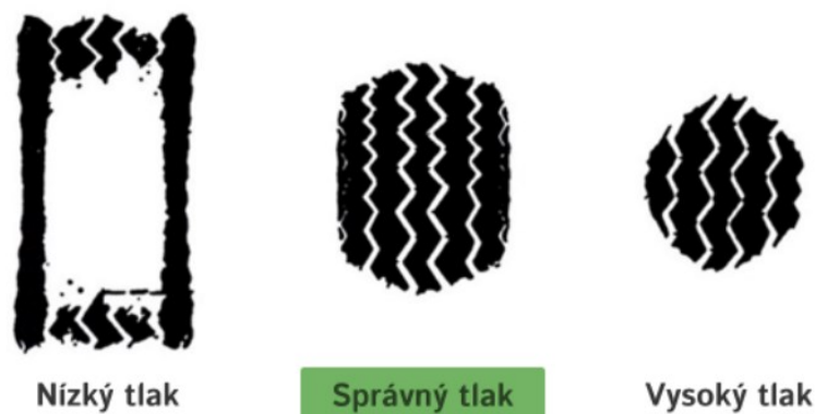
Obr. 2: Tvar a velikost stykové plochy podle nahuštění pneumatiky [5]
