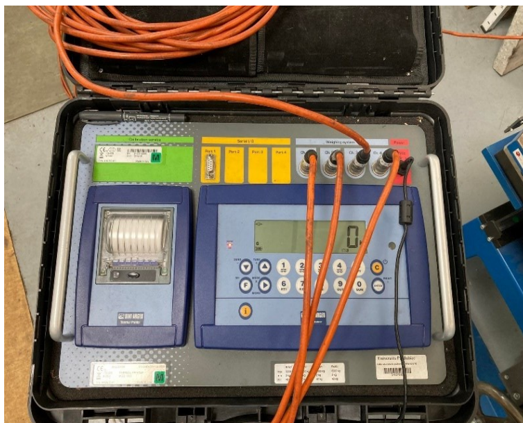
Obr. 29: Měřicí stanice nájezdových vah
