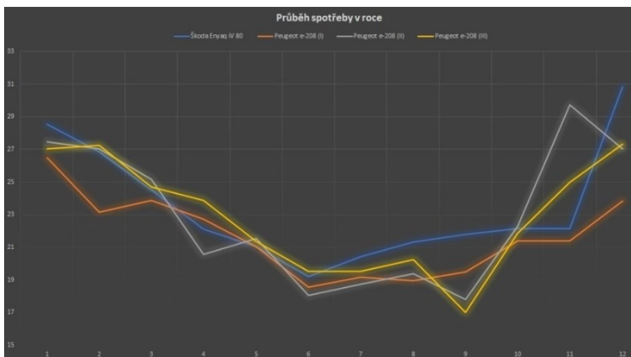
Obrázek 13 Průměrná spotřeba 4 EV během roku (1 x Škoda Enyaq iV 80, 3x Peugeot e-208 s odlišnými uživateli) (Sprintmonitor, 2021)
