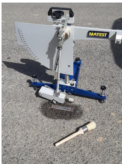
Obrázek 17: Měření protismykových vlastností v terénu pomocí kyvadla Matest
