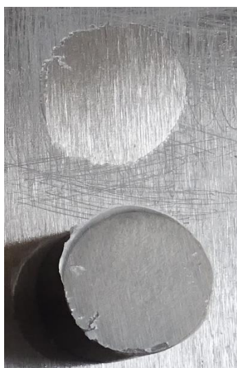
Adhezní typ lomu mezi nátěrem a podkladem A/B
