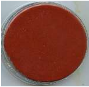
Obrázek 15: Organický pigment C_{26}H_{19}MgN_3O_5
