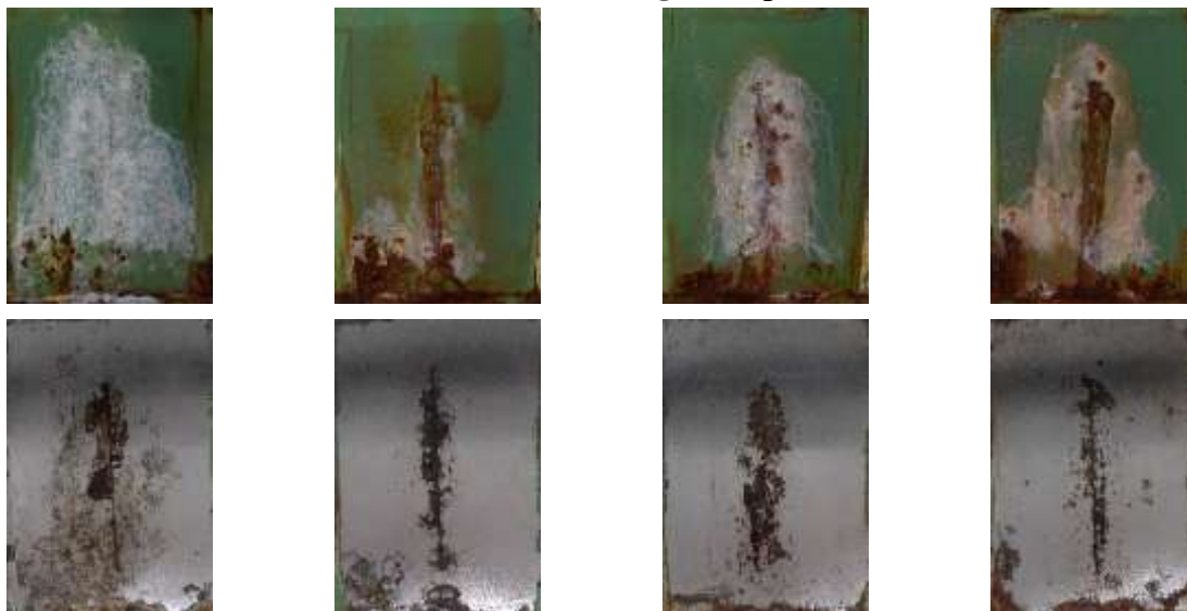
OP s obsahem sférického Zn a C_{17}H_{10}MgN_2O_3 při OKP = 1, 3, 5 a 10 %
