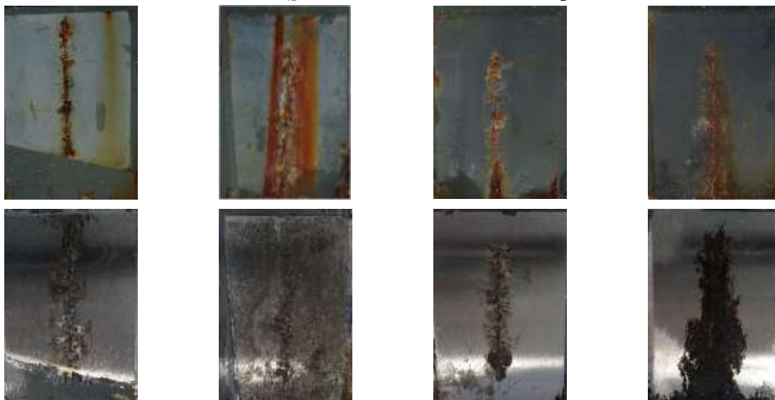
OP s obsahem sférického Zn a ([C_6H_4NH]_2[C_6H_4N]_2)_n-PO_4 při OKP = 1, 3, 5 a 10 %
