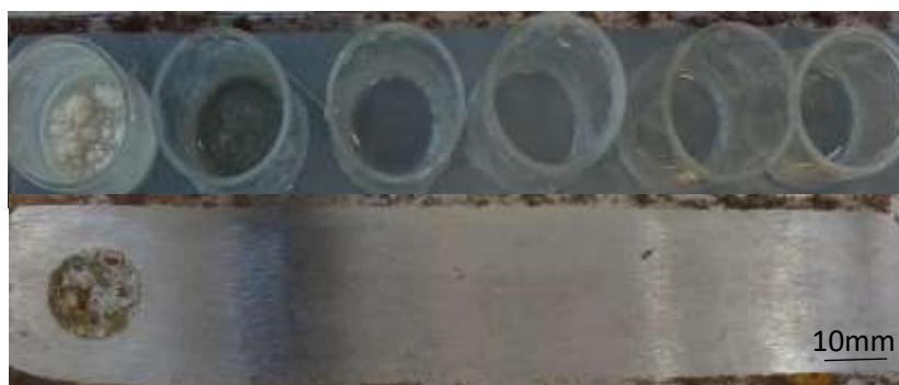
Obrázek 45: Fotografický záznam povlaku se sférickým Zn a pigmentem MgO při OKP = 10 %. Nahoře je vzhled organického povlaku po 10 týdnech působení vodného elektrolytu s 2M NaCl, dole je vzhled ocelového podkladu po odstranění nátěrového filmu a válečků.
