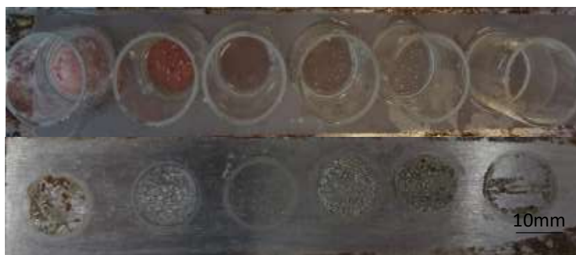
Obrázek 46: Fotografický záznam organického povlaku se sférickým zinkem a pigmentem \text{MgFe}_2\text{O}_4 při OKP = 10 %. Nahoře je vzhled organického povlaku po 10 týdnech působení vodního elektrolytu s 2M NaCl, dole je vzhled ocelového podkladu po odstranění nátěrového filmu a válečků.
