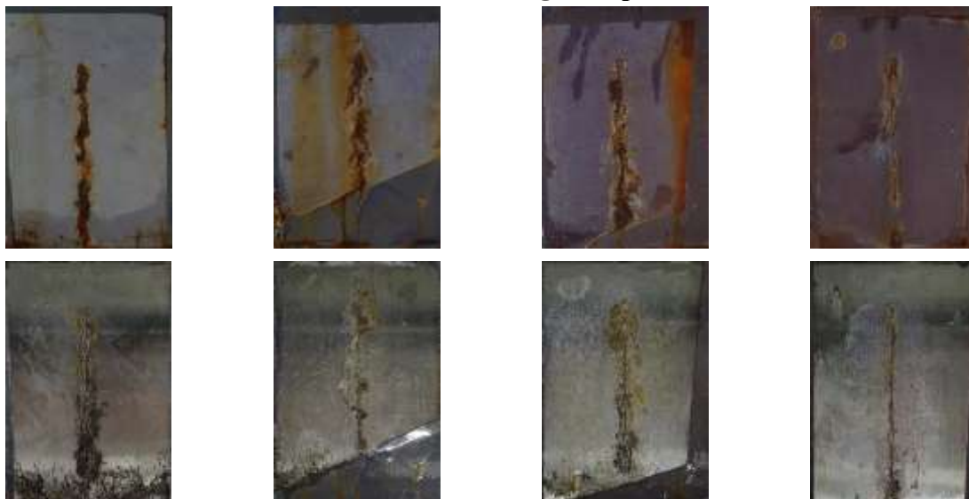
OP s obsahem sférického Zn a ([C_6H_4NH]_2[C_6H_4N]_2)_n-PO_4 při OKP = 1, 3, 5 a 10 %
