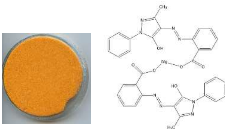
Obrázek 14: Organický pigment C_{34}H_{26}MgN_8O_6
