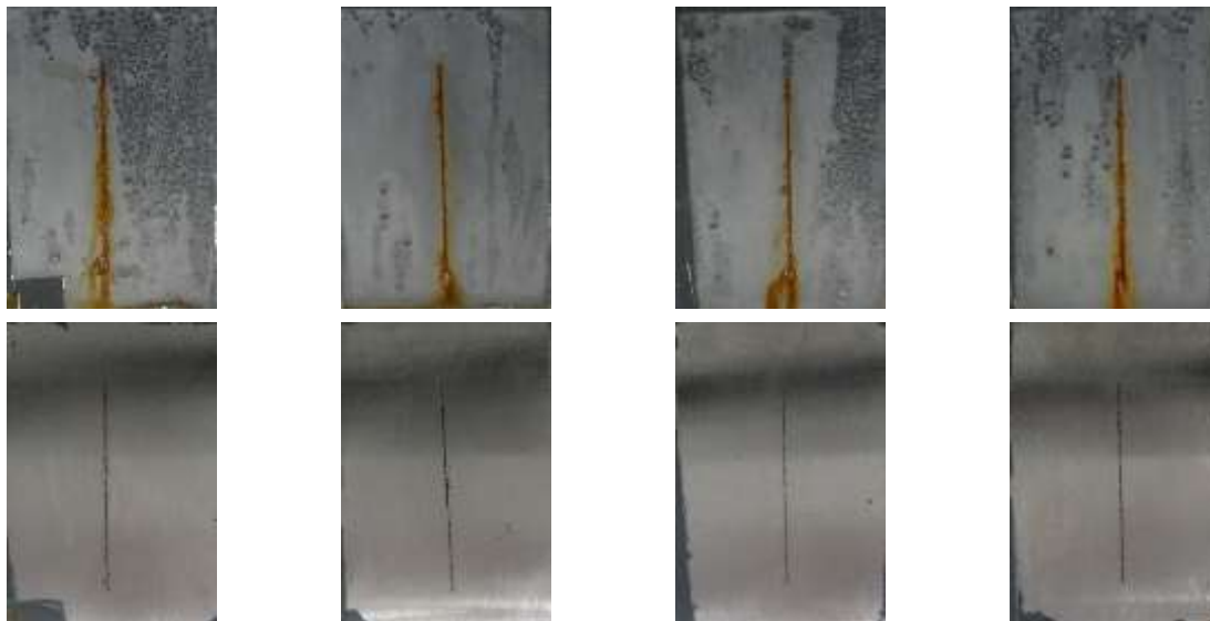
OP s obsahem sférického Zn a C_{16}H_{10}MgN_{12}O_{12} při OKP = 1, 3, 5 a 10 %
