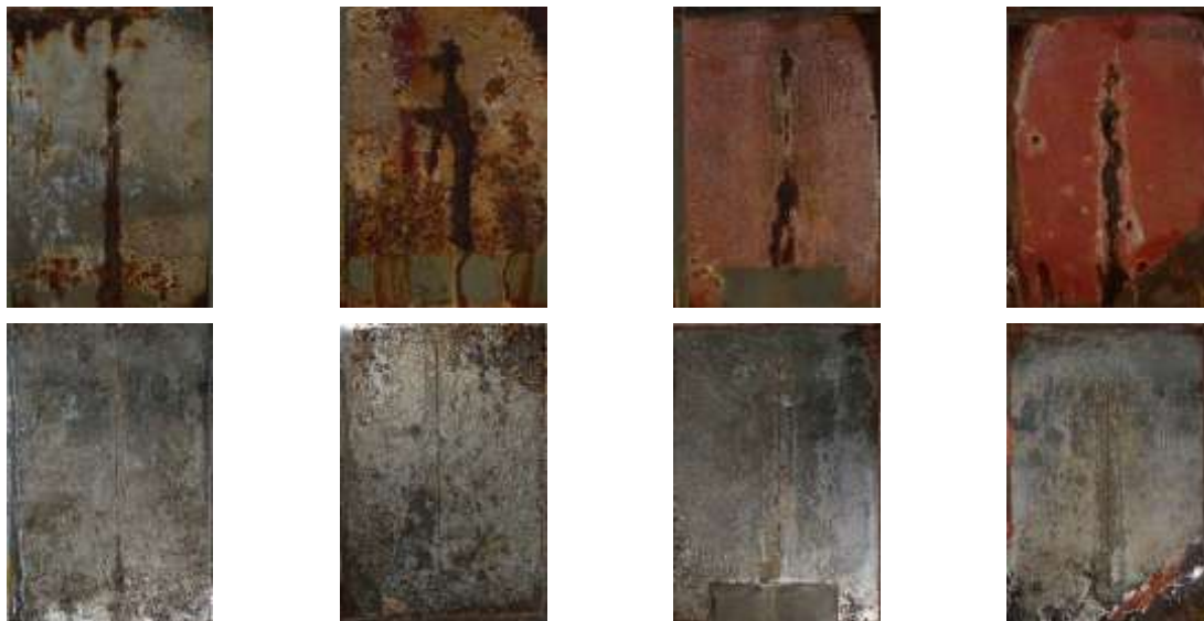
OP s obsahem sférického Zn a C_{25}H_{18}MgN_4O_6 při OKP = 1, 3, 5 a 10 %
