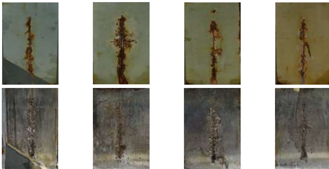
OP s obsahem sférického Zn a C_{34}H_{26}MgN_8O_6 při OKP = 1, 3, 5 a 10 %
