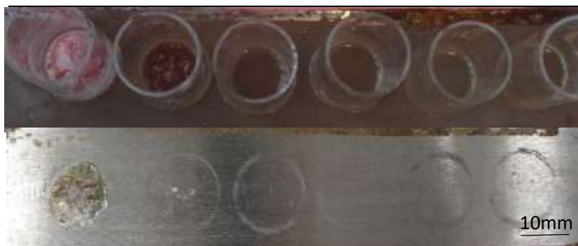
Obrázek 44: Fotografický záznam organického povlaku se sférickým zinkem a pigmentem C_{17}H_{10}MgN_2O_3 při OKP = 3 %. Nahoře je vzhled organického povlaku po 10 týdnech působení vodného elektrolytu s 2M NaCl, dole je vzhled ocelového podkladu po odstranění OP a válečků.
