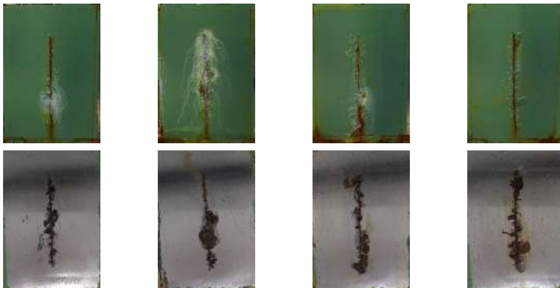
OP s obsahem sférického Zn a C_{26}H_{19}MgN_3O_5 při OKP = 1, 3, 5 a 10 %
