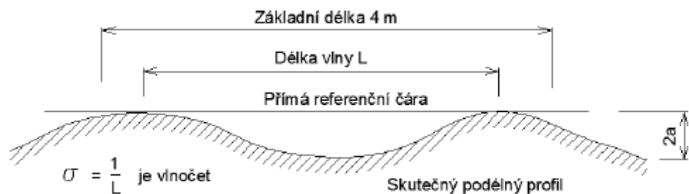
Obrázek 6: Měření podélné nerovnosti latí [4]
