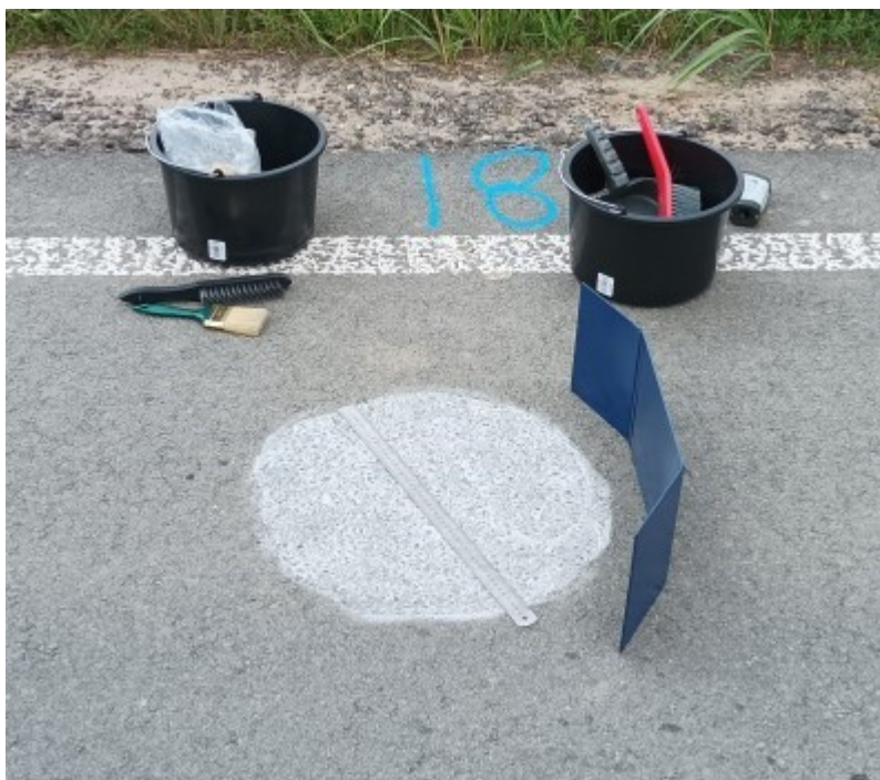
Obrázek 34: Zkušební sada na zkoušku MTD [21]
