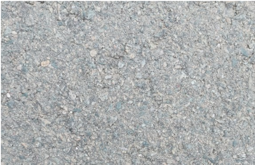
Obrázek 41: Úsek č 2: Ztráta makrotextury [21]
