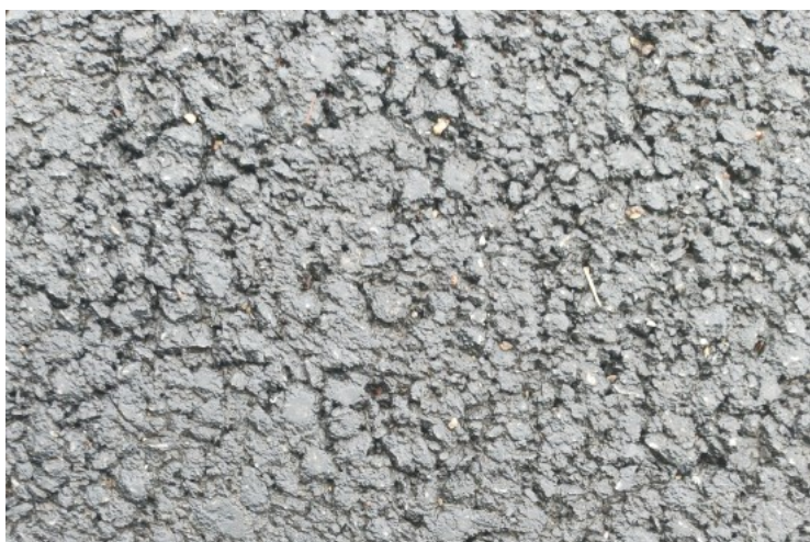
Obrázek 43: Úsek č 4: Makrotextura [21]
