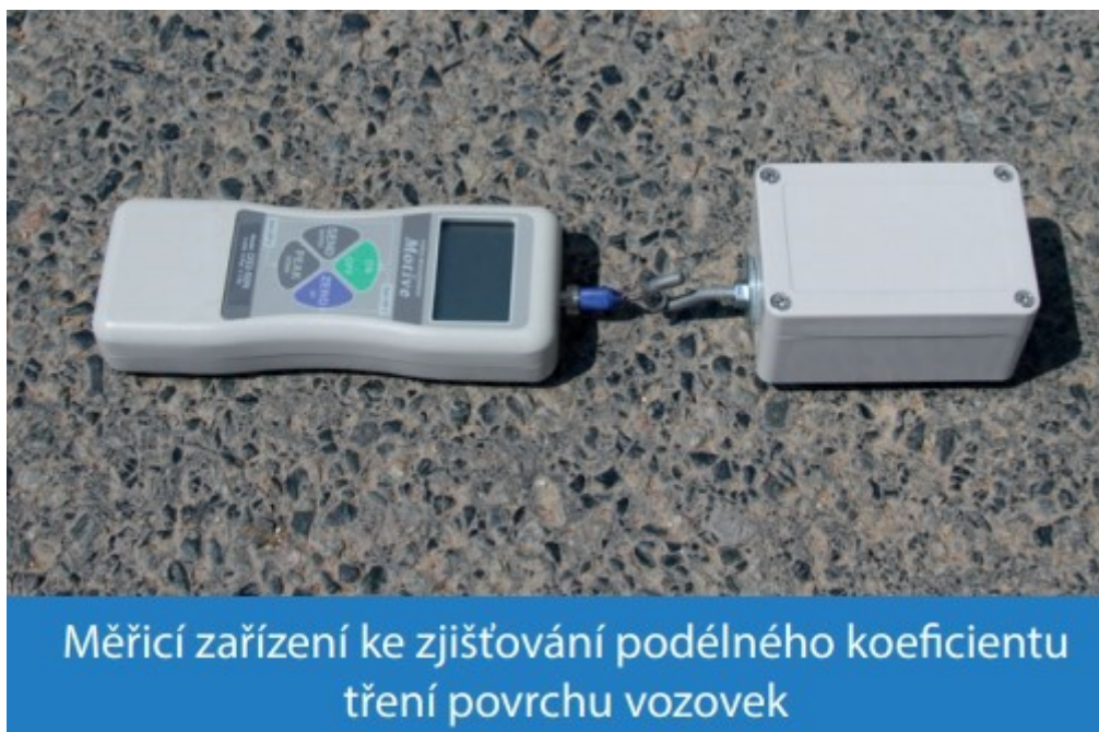
Obrázek 23: Měřicí zařízení ke zjišťování podélného koeficientu tření povrchu vozovek [10, 17]
