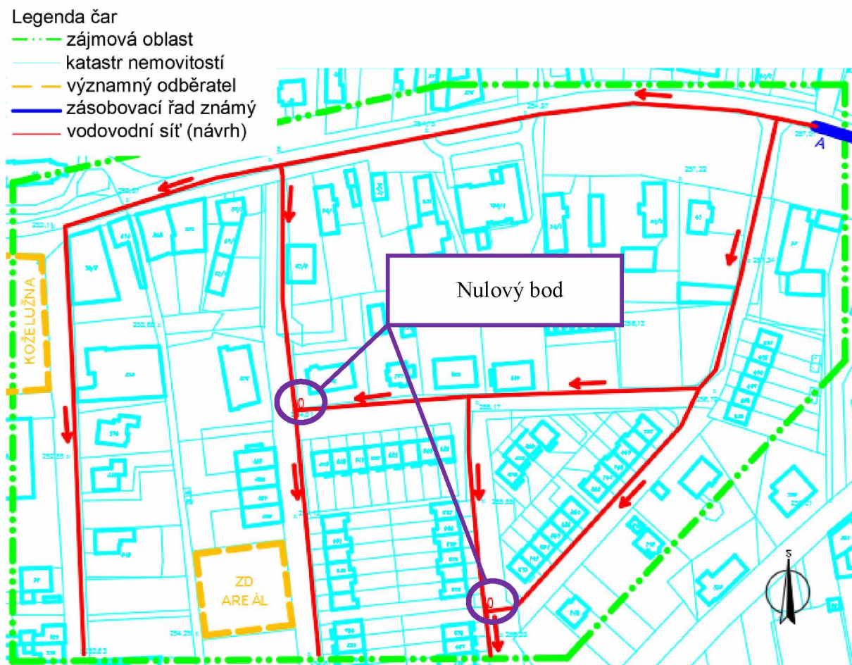
Obr. 6.3 Situace s vyznačenými nulovými body
