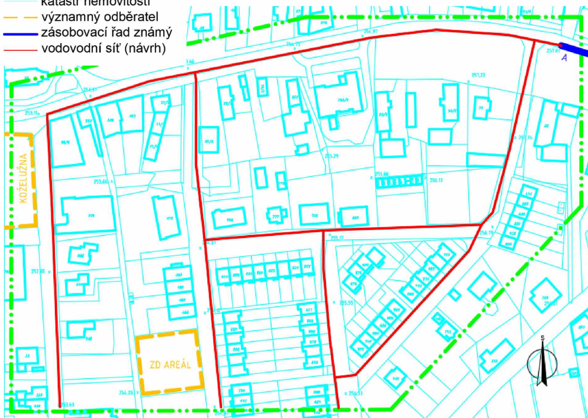
Obr. 6.2 Situace s návrhem rozmístění vodovodní sítě
