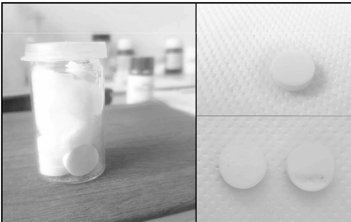
Ilustrace 18 - Lisovaná jádra připravená pro potažení, jádro Formulace 1 (bez vad), dvě jádra Formulace 3 (vada na jednom z jader)
