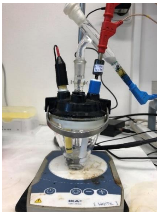
Obr. 9. Tříelektrodevý systém s laboratorním stojanem a magnetickým míchadlem.
