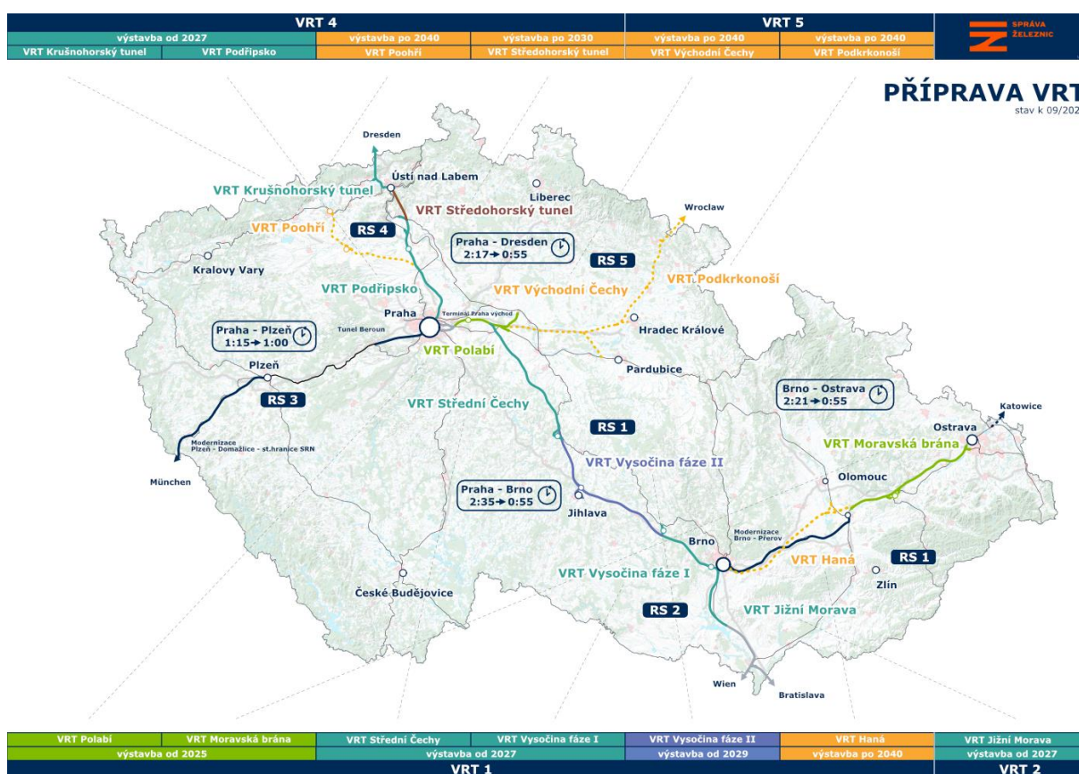
Obrázek 2 – Schéma navržených rychlých spojení
