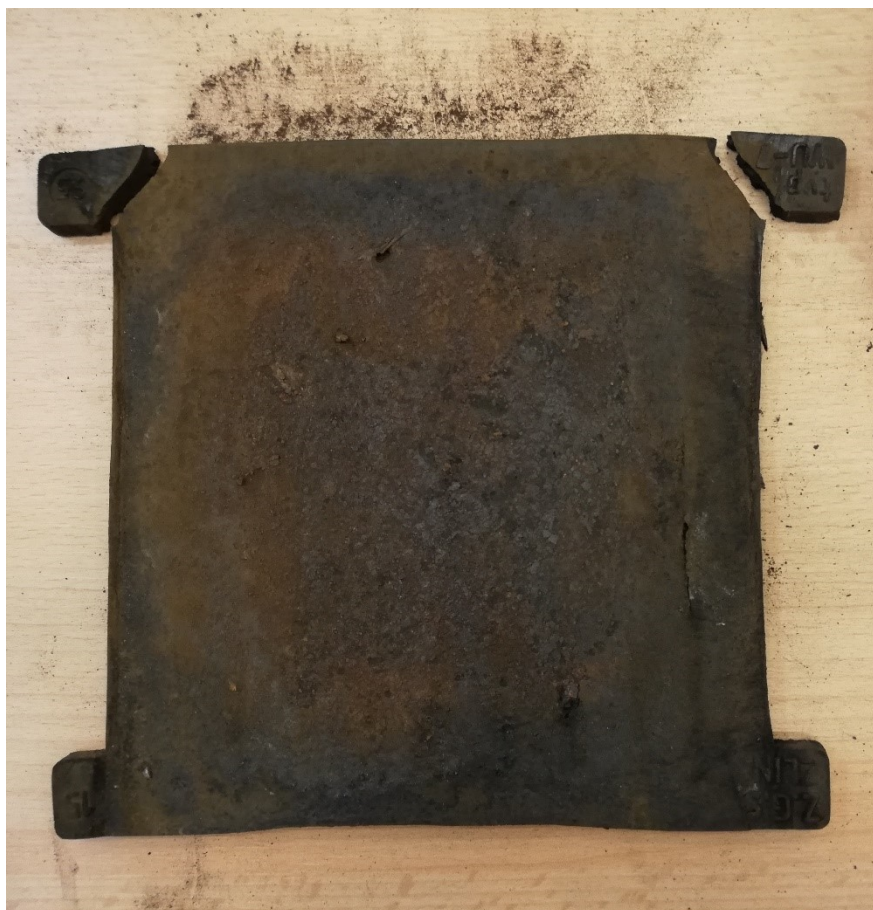
Obrázek 43: Održené kraje pryžové podložky WU - 7, vzorek V14
