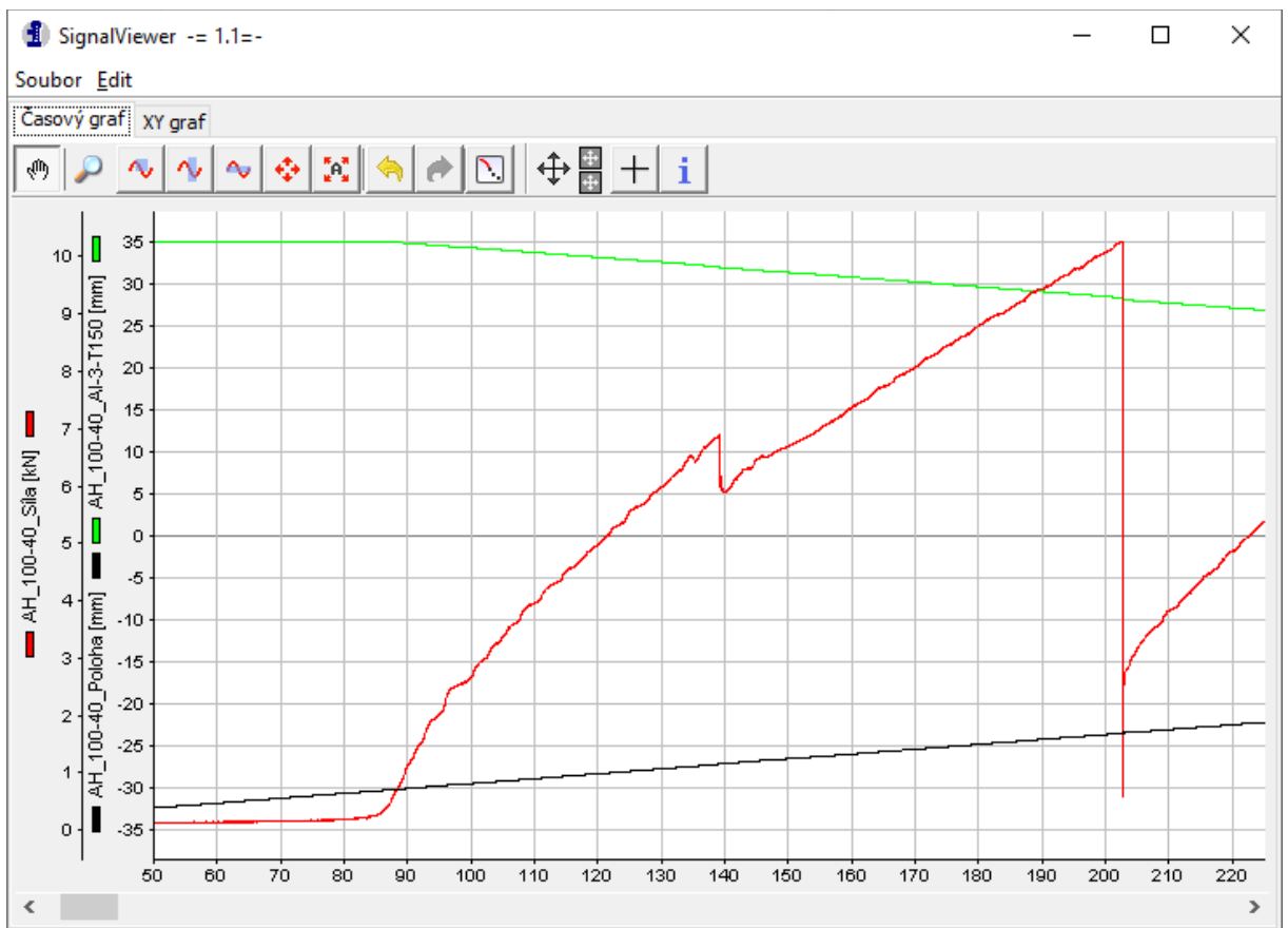
Obrázek 28: Detail nárůstu síly při zkoušce vzorku V05
