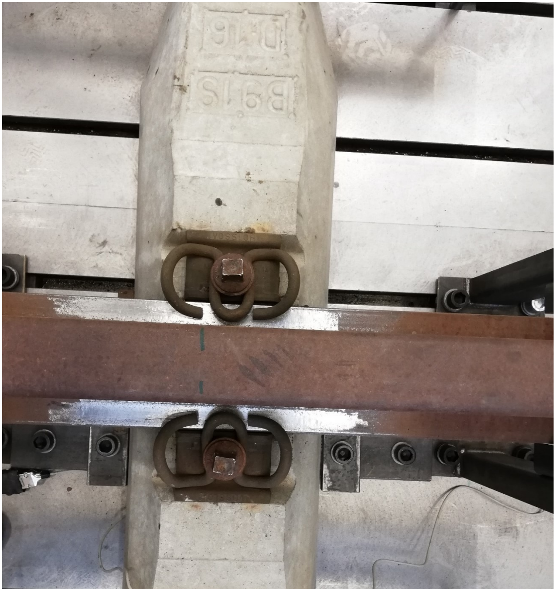
Obrázek 35: Fotografie vzorku V09 při zkoušce s viditelnou deformací
