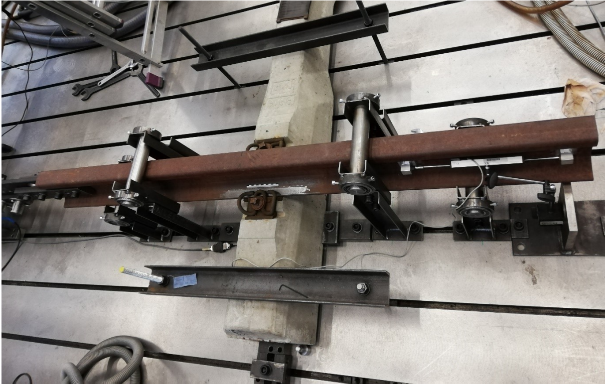
Obrázek 13: Zkouška pružného upevnění Vossloh W 14
