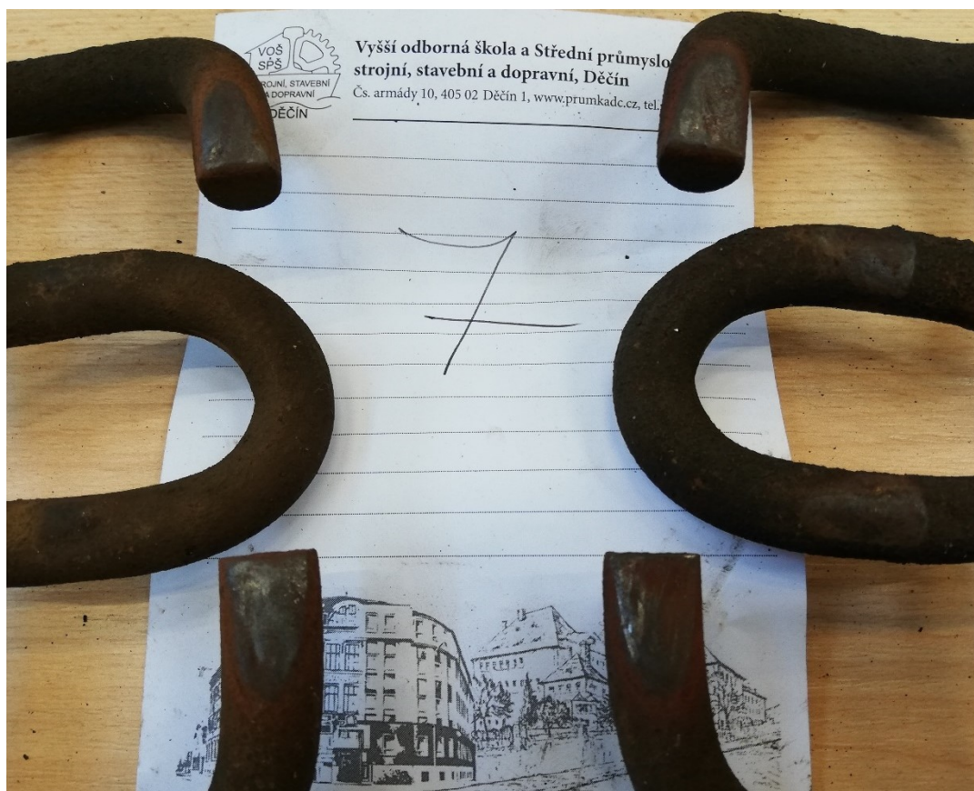
Obrázek 45: Opotřebované svěrky Skl 14 vzorku V07
