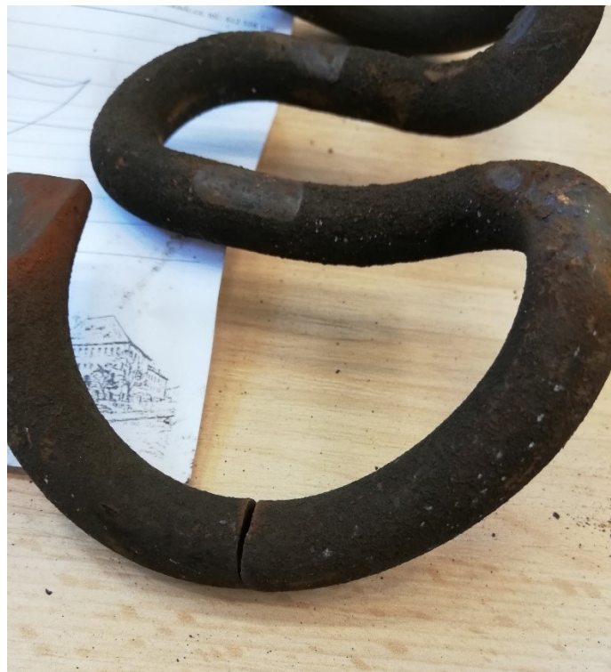
Obrázek 12: Prasklé rameno svěrky vzorku V07, únavová porucha
