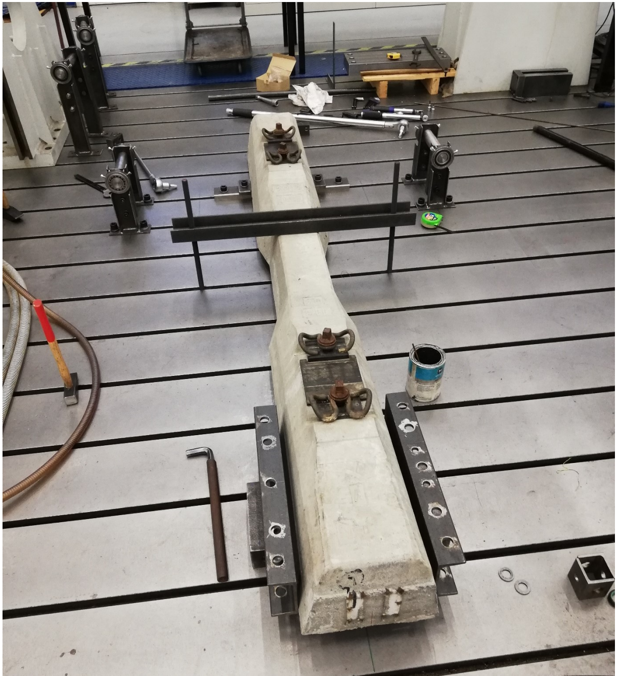
Obrázek 25: Montáž zkušební sestavy
