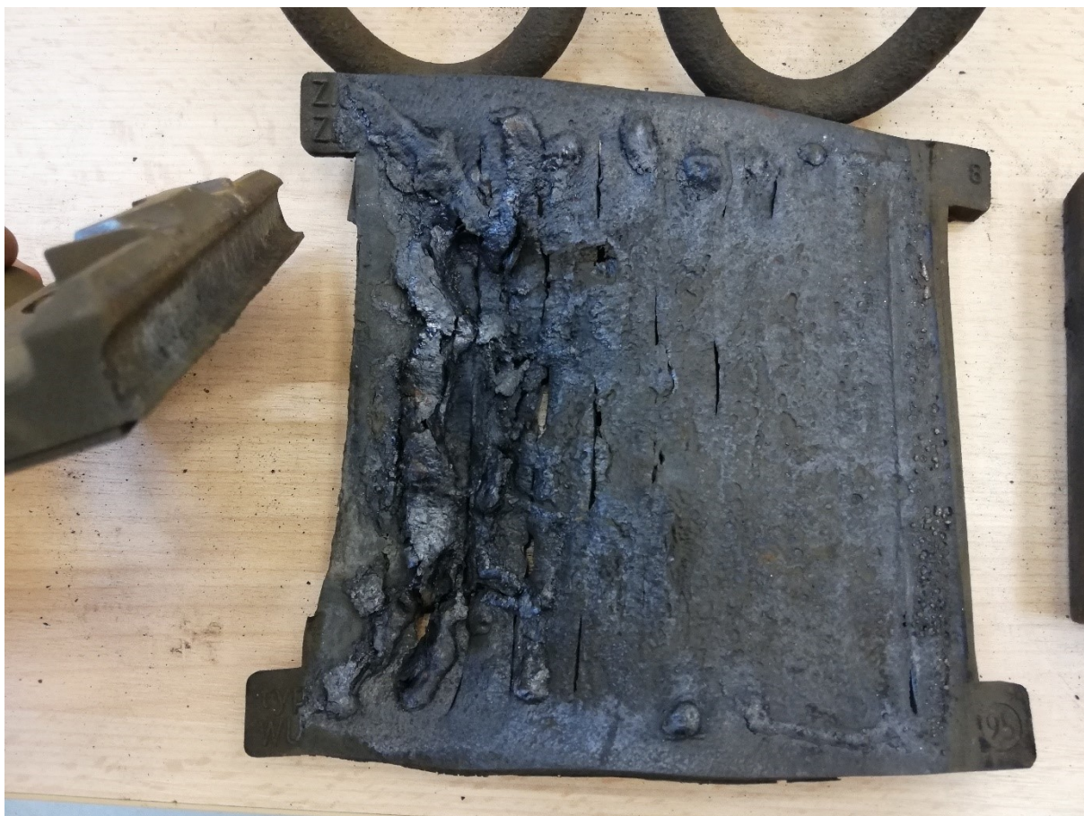
Obrázek 44: Úhlová vodící vložka Wfp- 14K a pryžová podložka Wu – 7 vzorku V11
