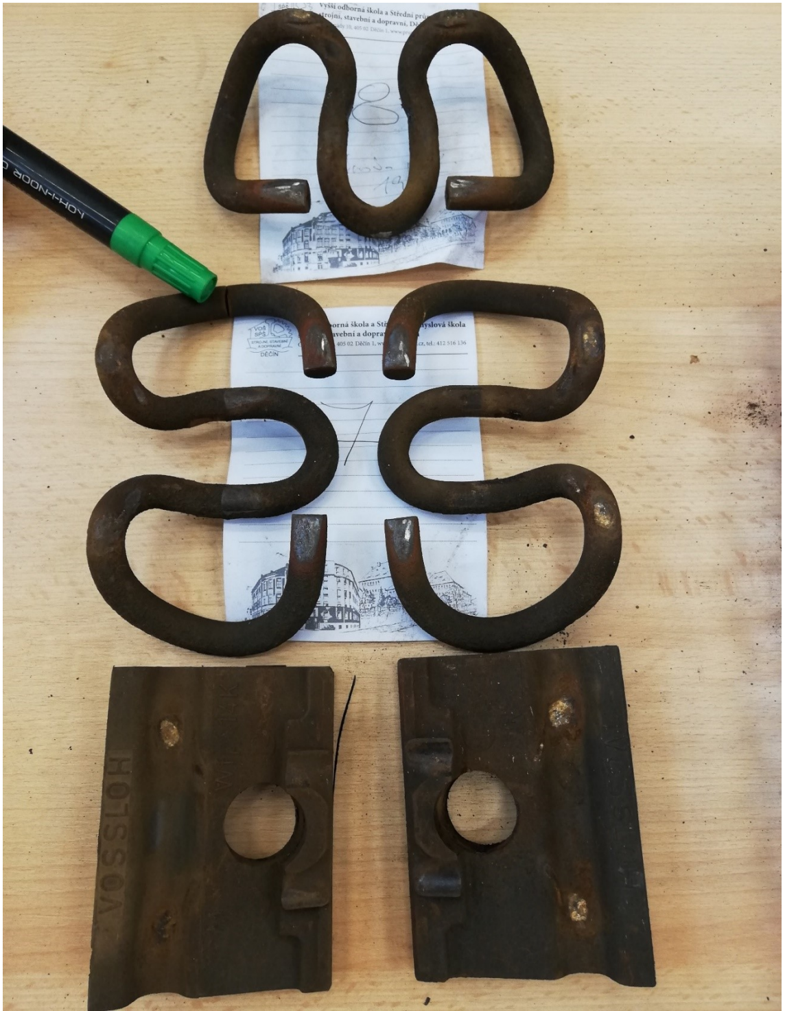
Obrázek 8: Vzorek V07 se svěrkou ze vzorku V08 nahrazující prasklou svěrkou
