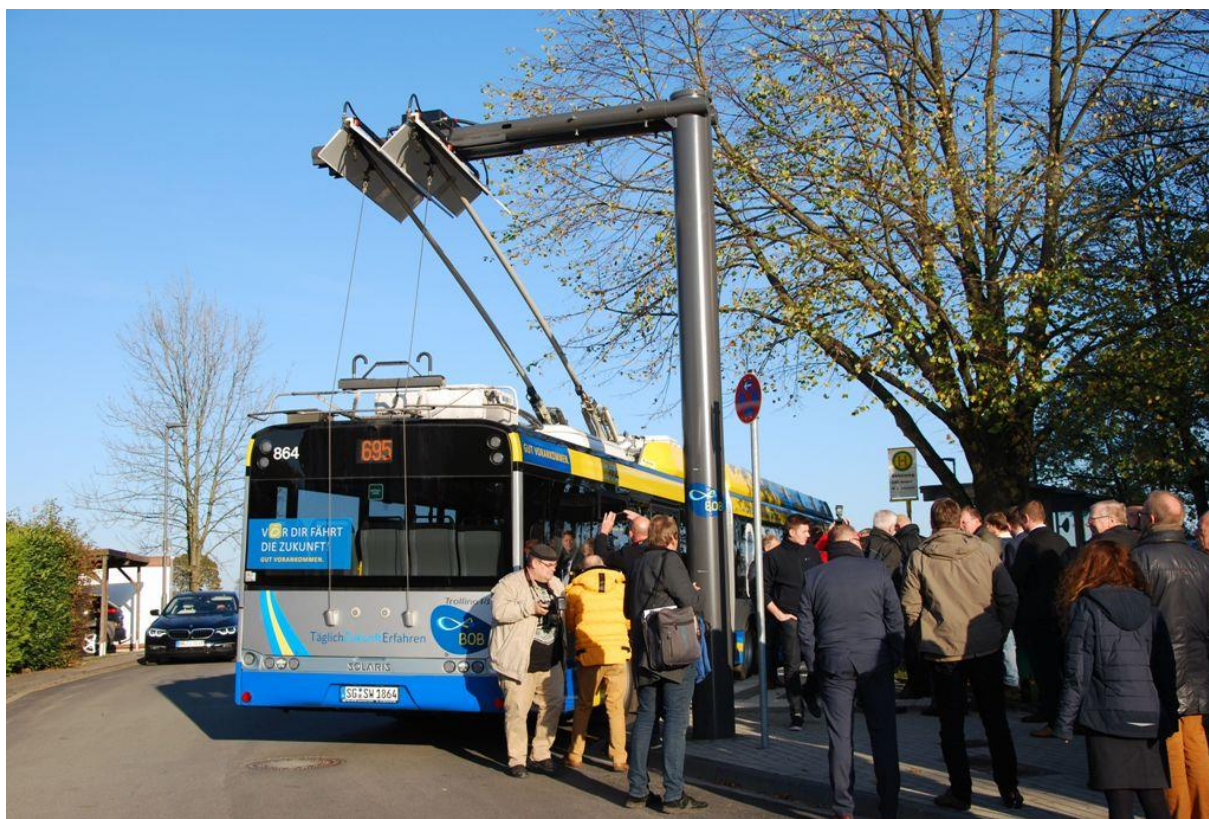
Obrázek A4 Rychlonabíjecí stojan v německém Solingenu. Dalším nezbytným příslušenstvím jsou speciální sběrací hlavice trolejbusů Zdroj: (10)
