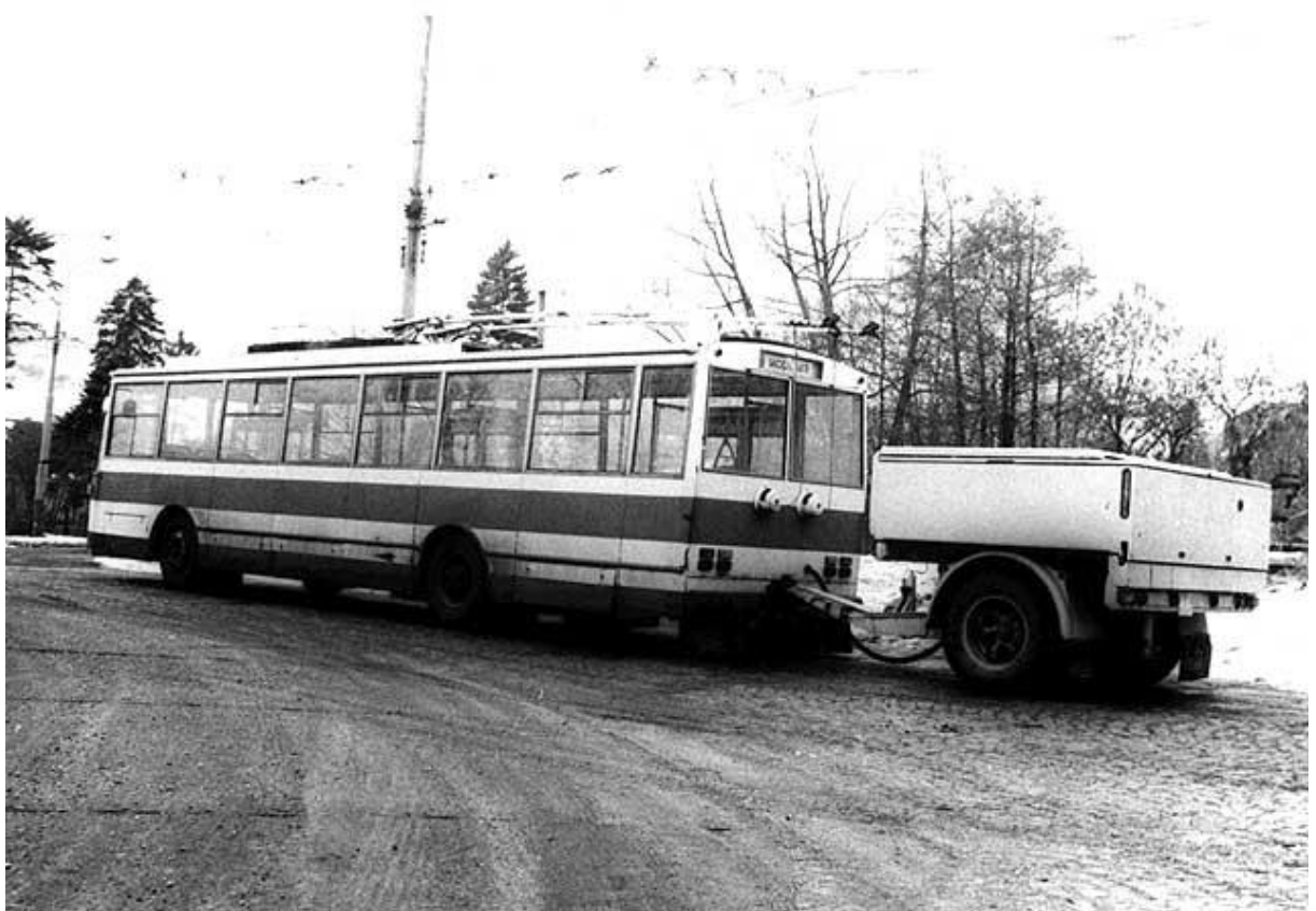
Obrázek N2 Trolejbus Škoda 14 Tr s přívěsným vozíkem s akumulátory. Dle kapacity baterií lze tento trolejbus vnímat jako parciální trolejbus Zdroj: (11)
