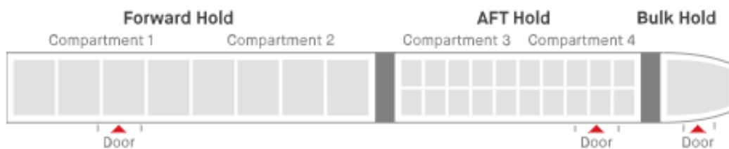
Obrázek 10: Plánek nákladového prostoru Boeingu 777-300
