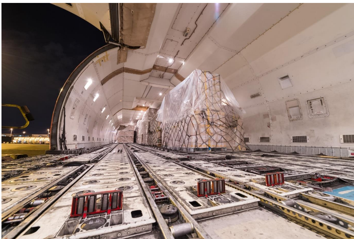
Obrázek 7: Mechanismy pro manipulaci a zajištění nákladu na palubě letadla
