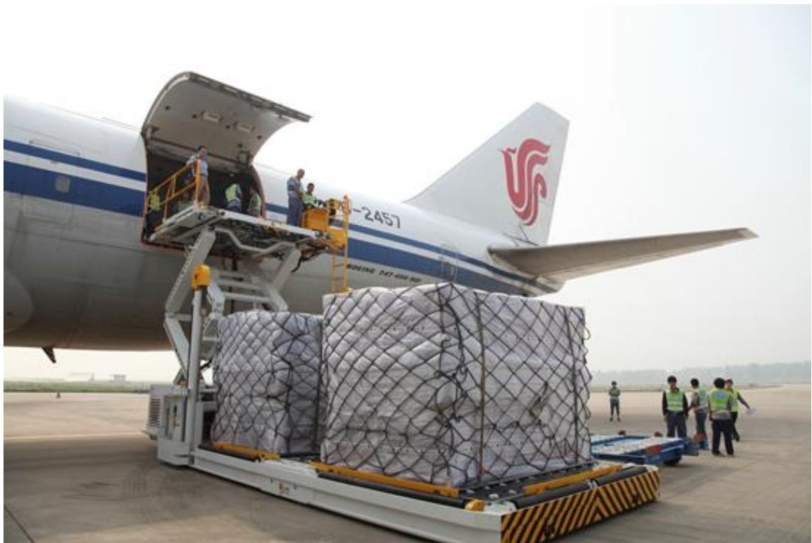
Obrázek 5: Nakladač ULD palet a kontejnerů během nakládky letadla
