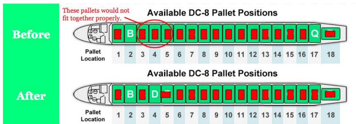
Obrázek 8: Poloha ULD palet, jak měly být naloženy a jak byly naloženy ve skutečnosti
