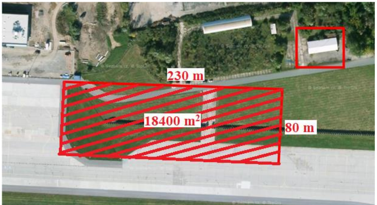
Obrázek 14: Vyznačení možného rozšíření odbavovacích ploch
