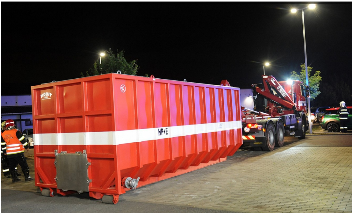
Obrázek 33 Kontejner pro hašení elektromobilů (HZS ČR, 2020)
