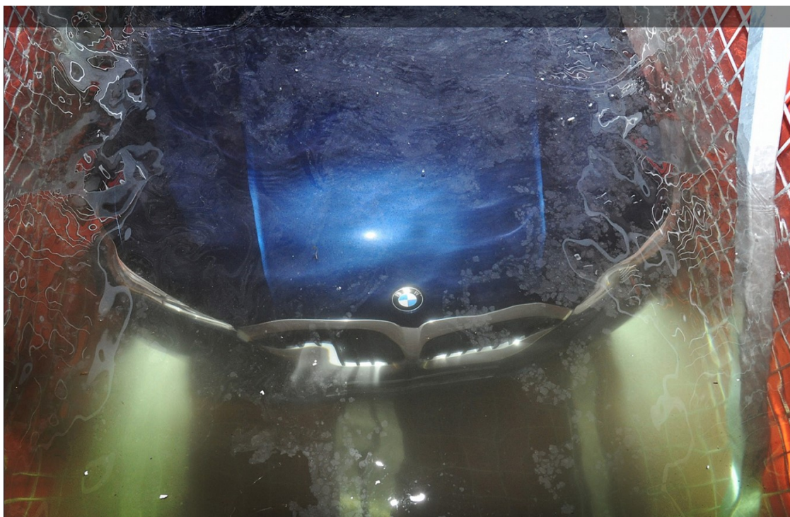
Obrázek 36 Elektromobil v kontejneru zalitý vodou (HZS ČR, 2020)
