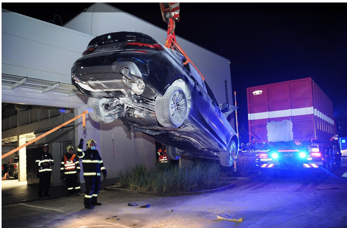
Obrázek 34 Přemístění elektromobilu do kontejneru (HZS ČR, 2020)
