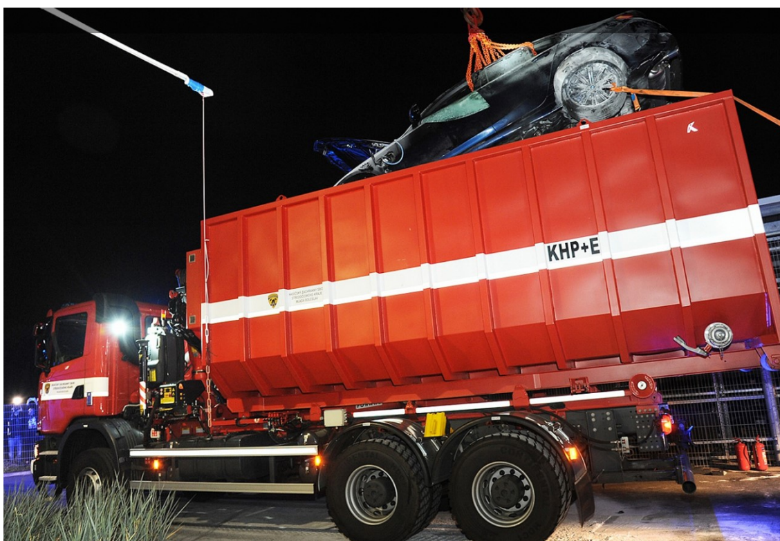
Obrázek 35 Vkládání elektromobilu do kontejneru pomocí jeřábu (HZS ČR, 2020)
