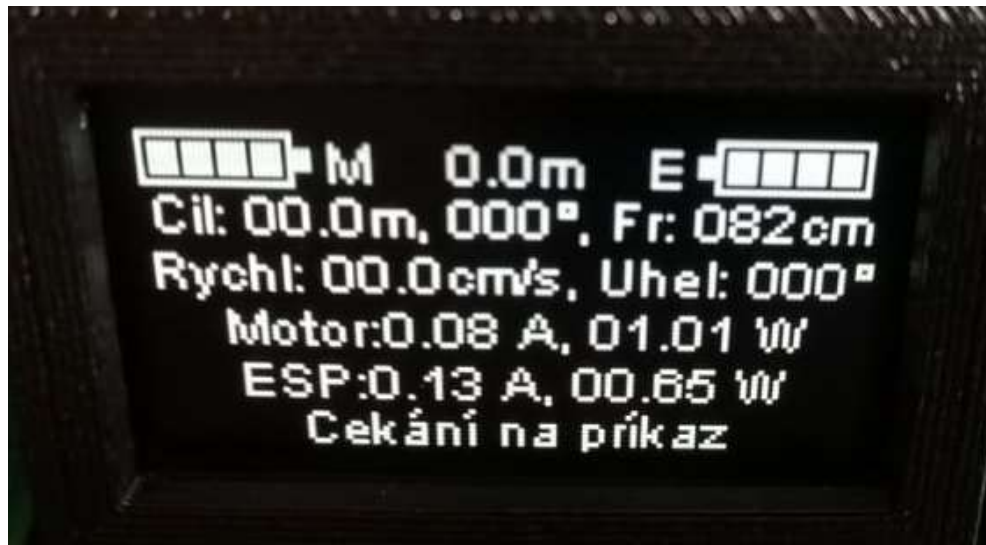
Obr. 2.17 – Vizualizace dat na OLED displeji
