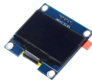
Obr. 1.16 – OLED displej SSH1106
