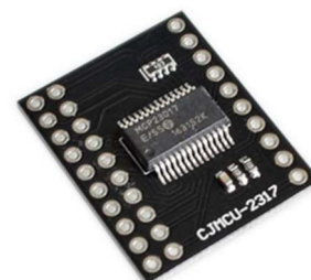
Obr. 1.5 – Rozšiřující I/O modul MCP23017
