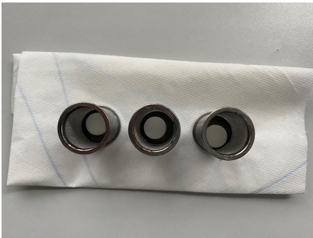
Obrázek 29: Původně potahované matricové tablety po disolučním testování – již bez potahu, který se zcela rozpustil v médiu s obsahem 40 obj. % alkoholu
