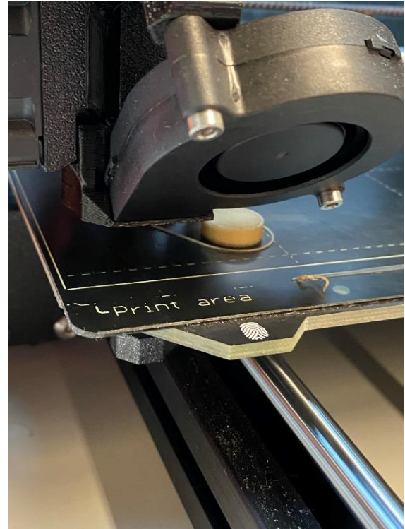
Obrázek 24: 3D tiskárna potahující matricovou tabletu
