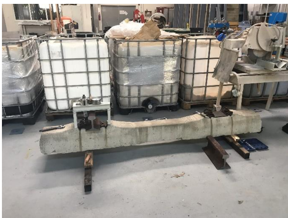
Obr. 4-37: Uspořádání sestavy pro zkoušení svěrné síly
