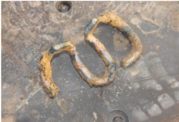
Obr. 1-17: Prasklá svěrka Skl14 vyjmutá z přejezdu v žst. Kolín
