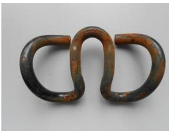
Obr. 4-35: Vzorek s povrchovou úpravou KTL po všech laboratorních korozních zatěžováních a ošetření mořicím roztokem
