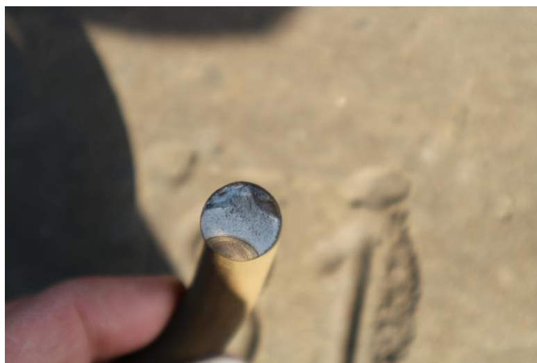
Obr. 7-59: Detail poškození vnějšího ramene svěrky
