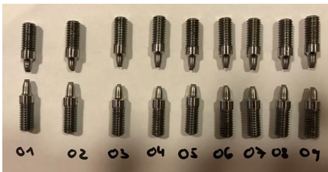
Obr. 4-7: Poškozené vzorky po tahové zkoušce
