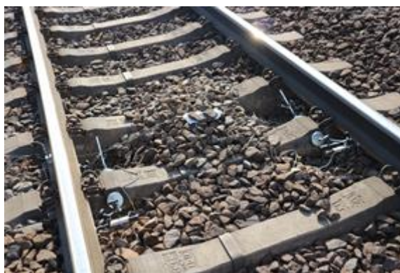
Obr. 7-51: Umístění snímačů posunu
