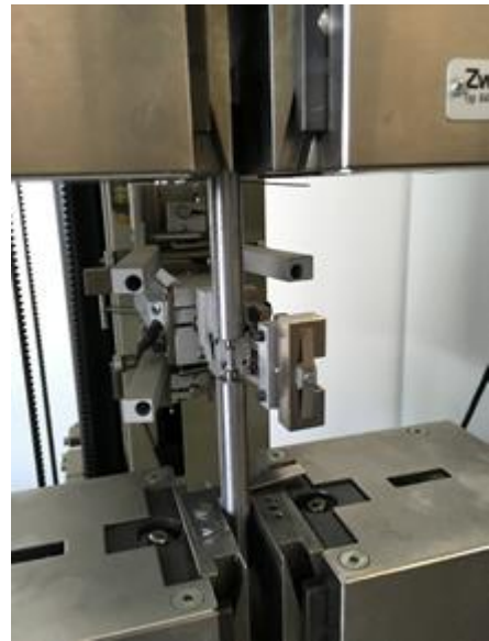
Obr. 4-4: Vzorek upnutý do čelistí pro tahovou zkoušku
