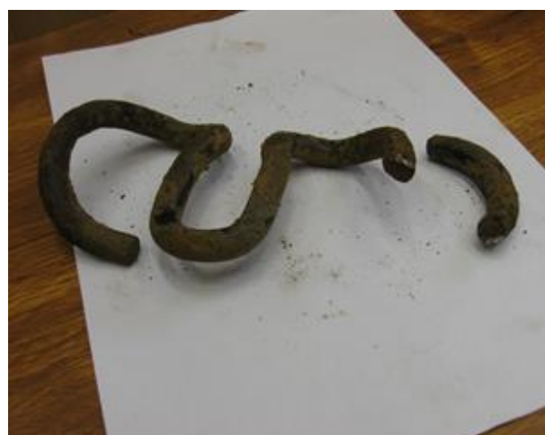
Obr. 7-5: Svěrka z Kolína s uměle dolomeným ramenem
