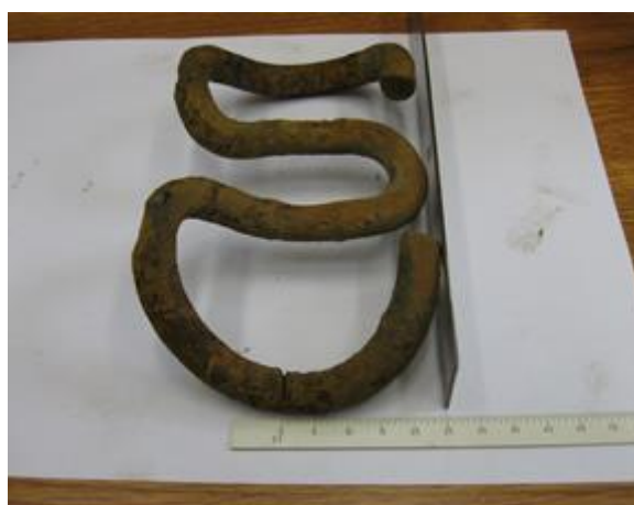
Obr. 7-4: Svěrka z Kolína s nalomeným ramenem
