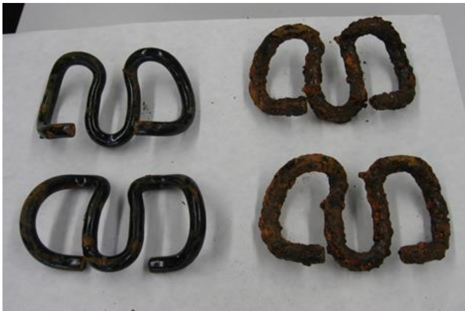
Obr. 4-30: Vzorčky po 1720 h zatěžování v korozní komoře. Vlevo vzorčky s povrchovou úpravou KTL, vpravo vzorčky bez antikorozní povrchové úpravy
