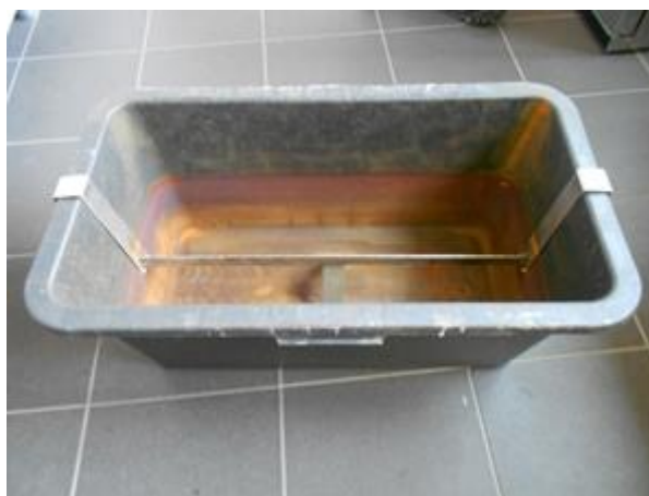
Obr. 4-31: Plastová nádoba s držákem na uchycení vzorků při ponorové zkoušce v roztoku elektrolytu
