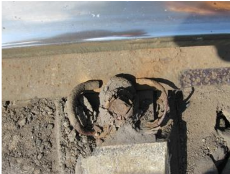
Obr. 1-13: Pružná svěrka Skl14 bez povrchové úpravy z přejezdu Dobříň
