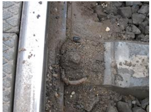
Obr. 1-20: Detail svěrky Skl14 s ulomeným ramenem v přejezdu žst. Kolín, tmavá plochy naznačuje kontakt svěrky s panelem přejezdové konstrukce
