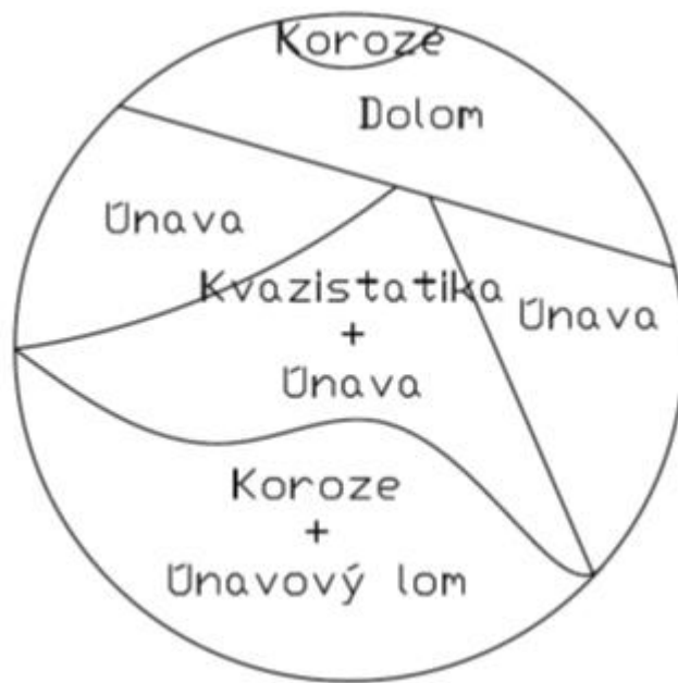
Obr. 7-8: Rozdělení ploch na povrchu vzorku s popisem příčiny vzniku poškození
