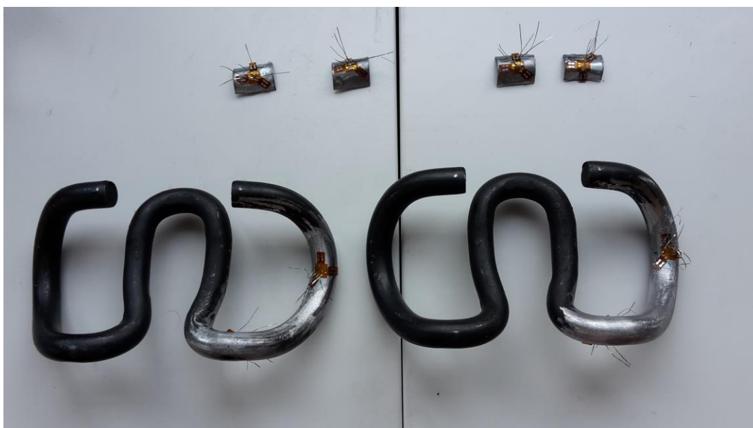
Obr. 7-23: Umístění tenzometrů na svěrce – vnější rameno – Označeno 1. Včetně kompenzačních tenzometrů
