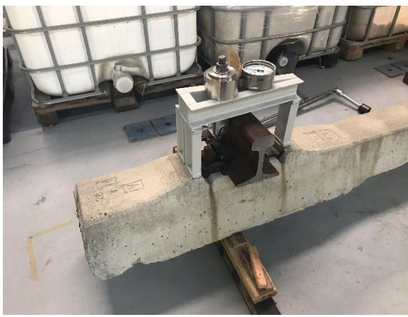
Obr. 4-38: Uspořádání sestavy pro zkoušení svěrné síly - detail
