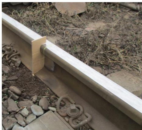
Obr. 7-44: Šablona pro umístění tenzometrů pro měření Y a Q
