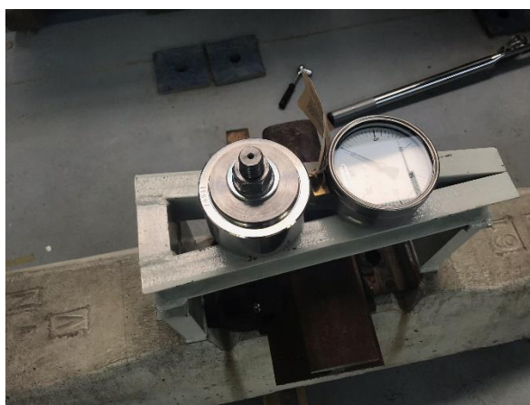
Obr. 4-40: Uspořádání sestavy pro zkoušení svěrné síly - pohled shora
