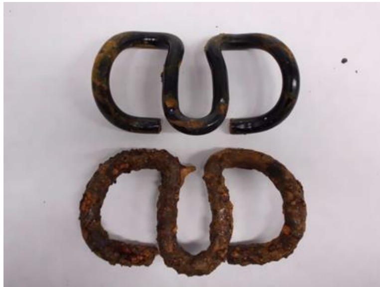
Obr. 4-29: Vzorčky po 1520 h zatěžování v korozní komoře. Nahoře vzorek s povrchovou úpravou KTL, dole vzorek bez antikorozní povrchové úpravy
