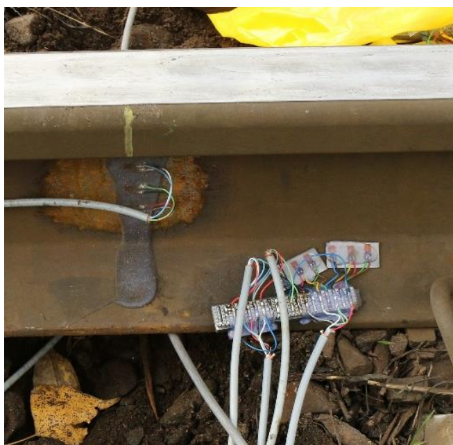
Obr. 7-45: Umístění tenzometrů na stojině kolejnice
