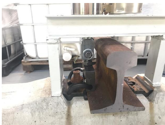
Obr. 4-39: Uspořádání sestavy pro zkoušení svěrné síly - pohled z boku
