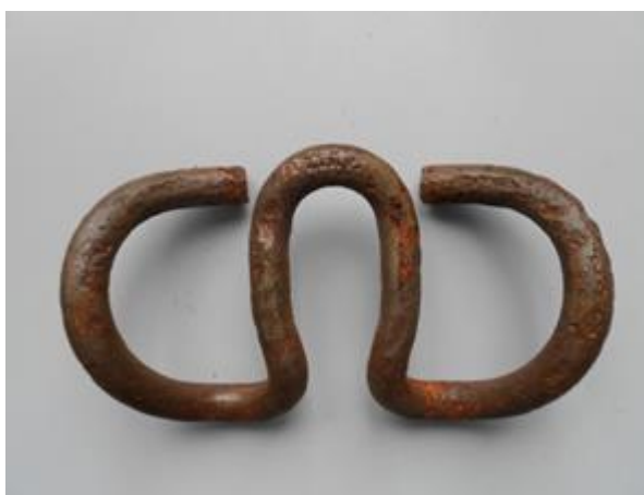
Obr. 4-34: Vzorek bez antikoroziční úpravy po všech laboratorních korozních zatěžováních a ošetření mořicím roztokem
