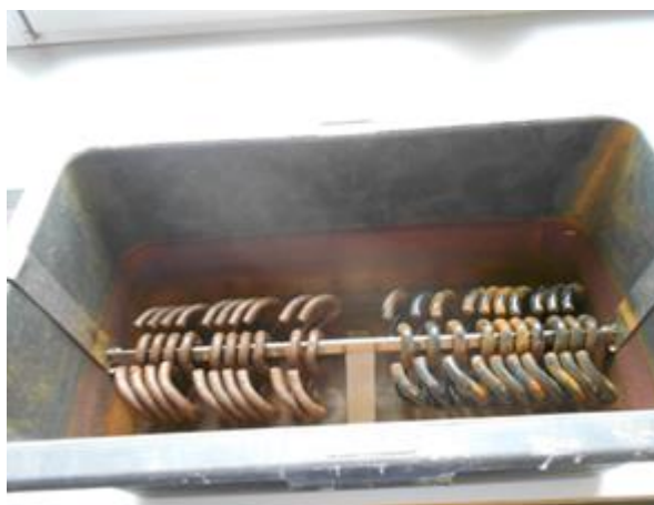
Obr. 4-32: Vzorky umístěné do nádoby pro ponorovou zkoušku v roztoku elektrolytu. Vzorky jsou po 1720 h v korozní komoře a 3 cyklech ponorové zkoušky + omytí mořicím roztokem. Vlevo – vzorky bez antikorozi povrchové úpravy, vpravo – vzorky s povrchem KTL
