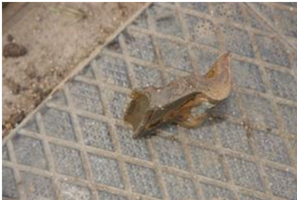
Obr. 1-21: Detail otlačení úhlové vodicí vložky
