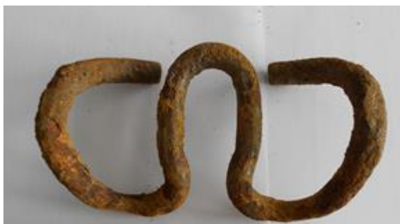
Obr. 1-5: Otisk panelu na vnějším rameni svěrky – žst. Kolín
