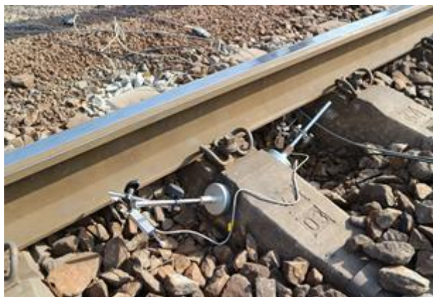
Obr. 7-52: Detail umístění snímačů posunu
