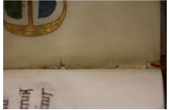
Obr. č. 57 Nařezání složek před šitím na zapuštěné vazy
