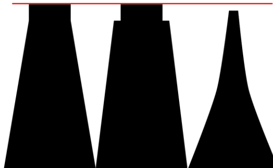
Obrázek č. 1: Možnosti tvarování tiskového bodu přímou gravurou
