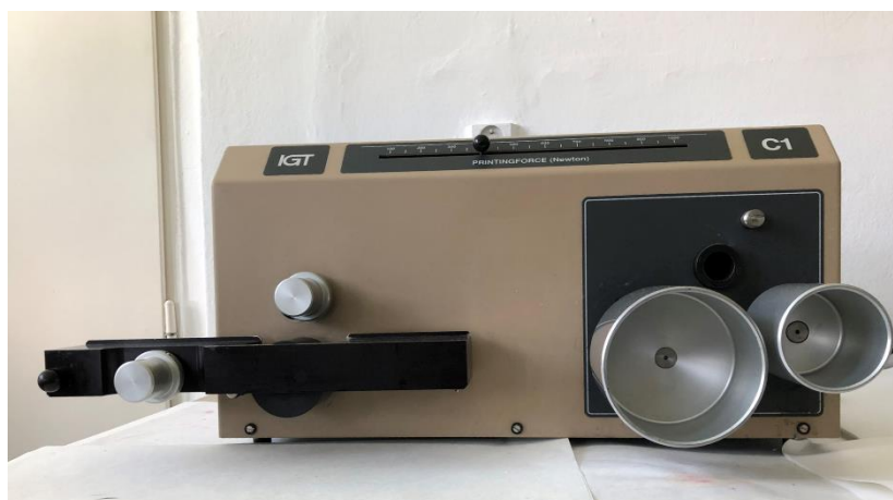
Obrázek 8 – Přístroj zkušební testovací IGT C1
