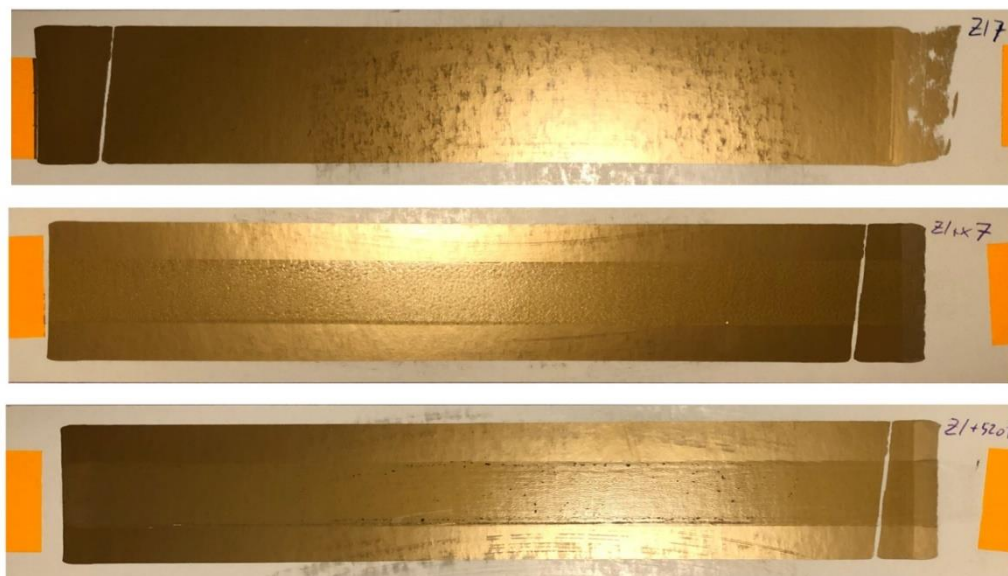
Obrázek 9 – Natisknuté vzorky (z vrchu zlatá barva, zlatá barva a primer „071“, zlatá barva a primer „520“)
