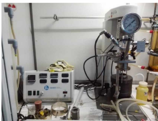
Obrázek 7: Tlakový reaktor Parr
