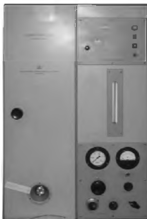
Obrázek 4: Plynový chromatograf model 154-B výrobce PerkinElmer z roku 1956 [47].
