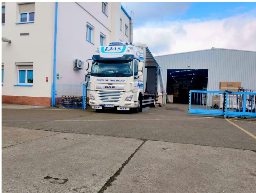
Obrázek 9 Vozidlo DAF CF vybavené třístrannou shrnovací nástavbou a zvedací plošinou (autor)
