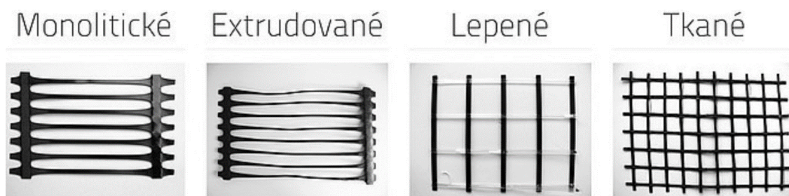
Obrázek 4 Monolitické, extrudované, lepené a tkané GGR [14]
