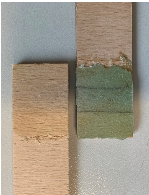
Obrázek 64: Dřevo – 3M Scotch-Weld DP8405NS
