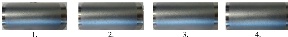
Obrázek 62. Fotografický záznam stanovení odolnosti lamelárním zinkem pigmentovaných povlaků ohybem přes válcový trn o průměru 4 mm: 1. standardní organický povlak, 2. organický povlak s obsahem PANI-H 3 PO 4 při OKP = 3 %, 3. organický povlak s obsahem PANI-BENZ při OKP = 3 %, 4. organický povlak s obsahem PANI-CAR při OKP = 3 %.
