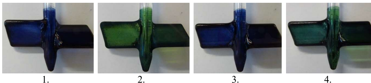
Obrázek 30. Záznam barevných změn v průběhu oxidační polymerace polyanilinových solí:
