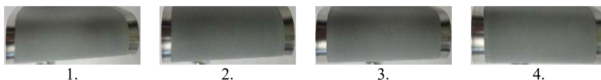
Obrázek 53. Fotografický záznam stanovení odolnosti povlaků ohybem přes válcový trn o průměru 4 mm: 1. standardní organický povlak, 2. organický povlak s obsahem PANI-H 3 PO 4 při OKP = 3 %, 3. organický povlak s obsahem PPy-H 3 PO 4 při OKP = 3 %, 4. organický povlak s obsahem PPDA-H 3 PO 4 při OKP = 3 %.
