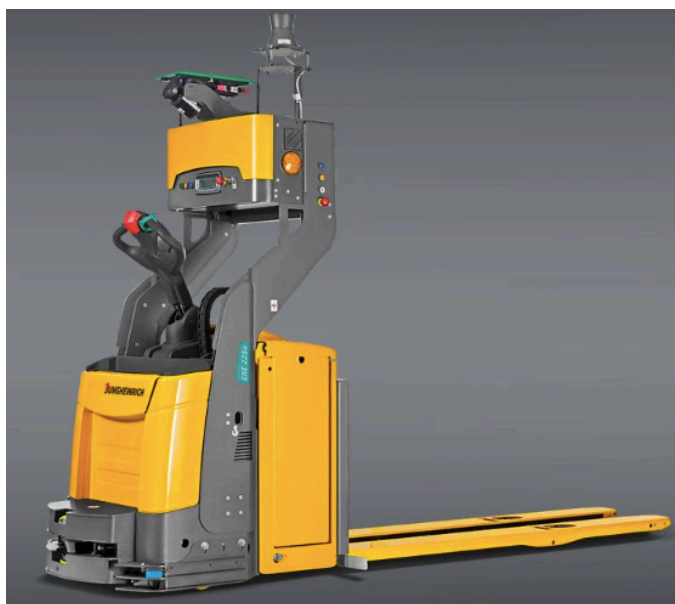
Obrázek 19: Automatizovaný nízkozdvíhý vozík
