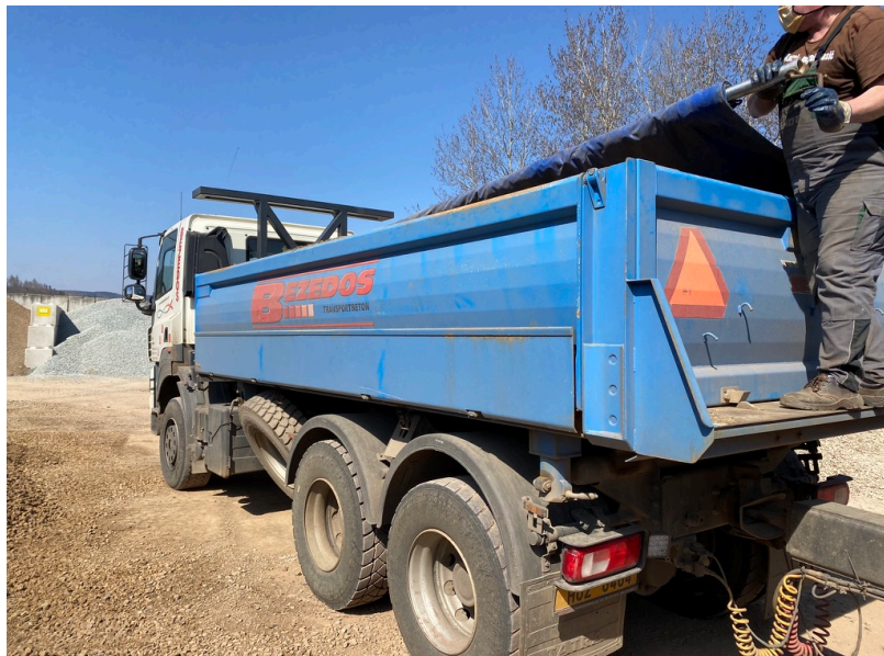
Obrázek 21 Odstranění plachty z nákladu
