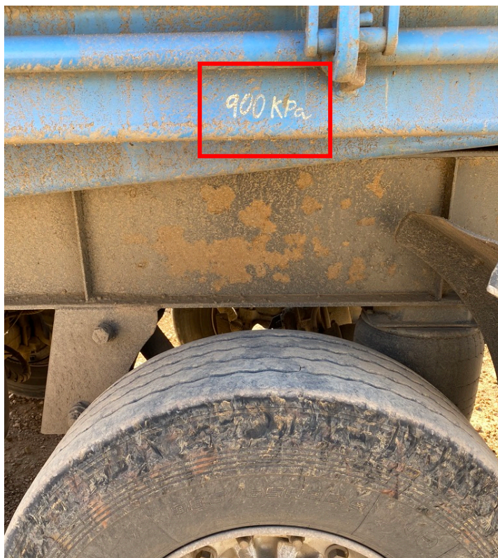
Obrázek 12 Hodnota tlaku v pneumatice
