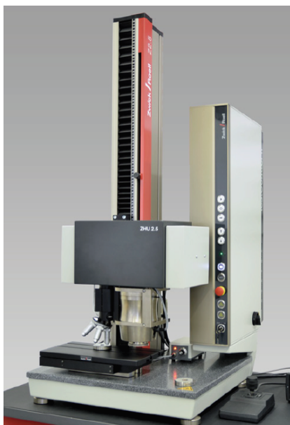
Obrázek 28: Univerzální tvrdoměr ZWICK ZHU2.5
