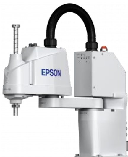
Obrázek 1.22 – Robot se SCARA architekturou (EPSON, 2020)
