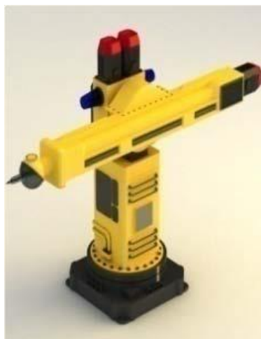
Obrázek 1.16 – Robot s TTT strukturou (Endeavor Business Media, 2013)
