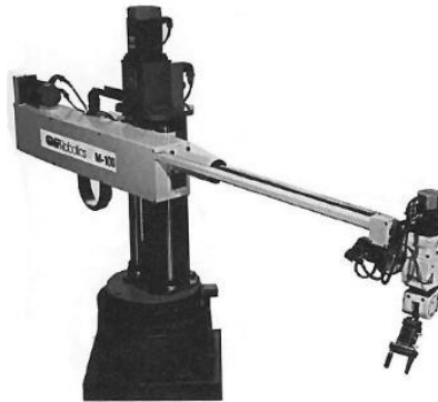
Obrázek 1.13 – Robot s RRT strukturou (Cylindrical Robots, 2020)
