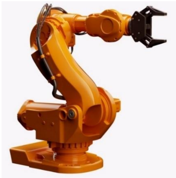
Obrázek 1.19 – Robot s RRR strukturou (Alibaba, 1999-2020)
