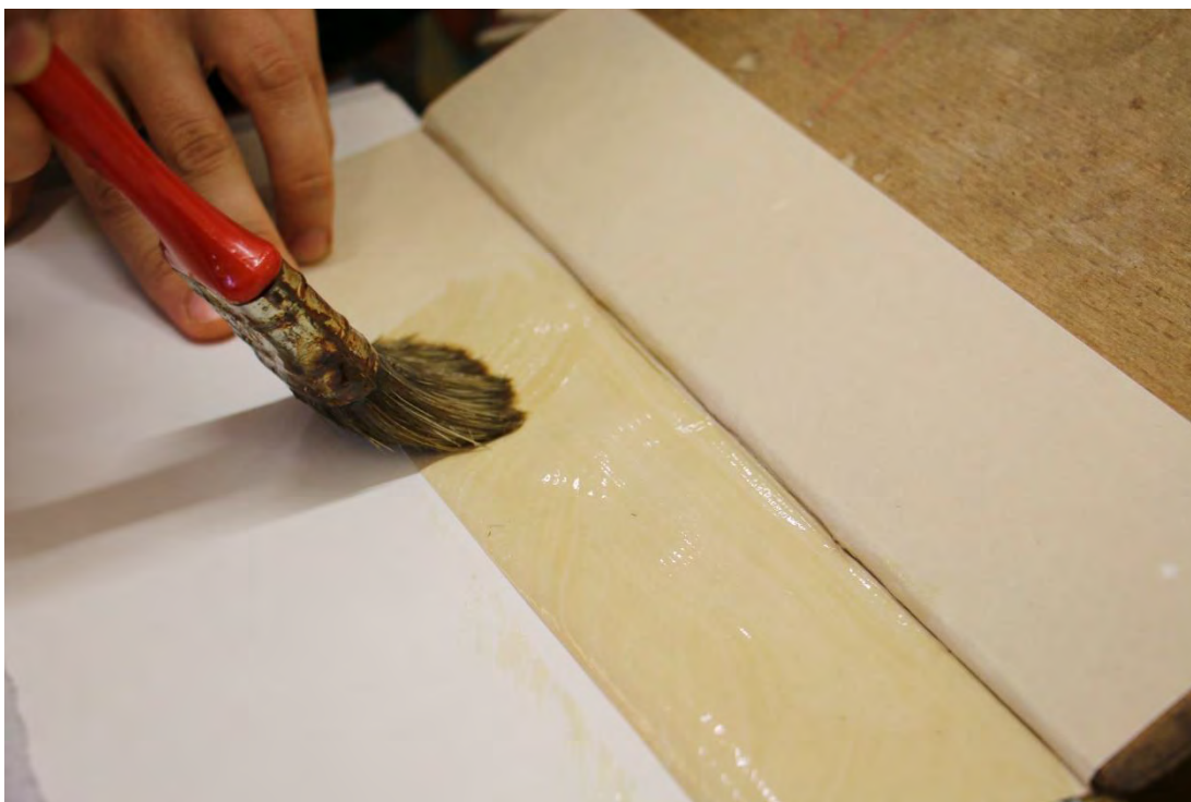
Obrázek 43 Lepení předsádkových křidélek kostním klijem
