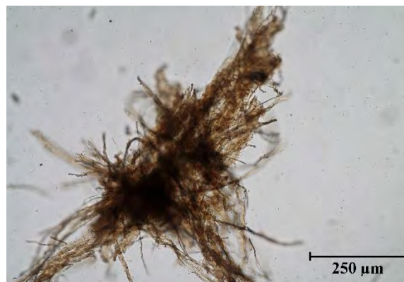
Obrázek 15 Vzorek rozvlákněné usně KV_1 po provedené důkazové zkoušce.
