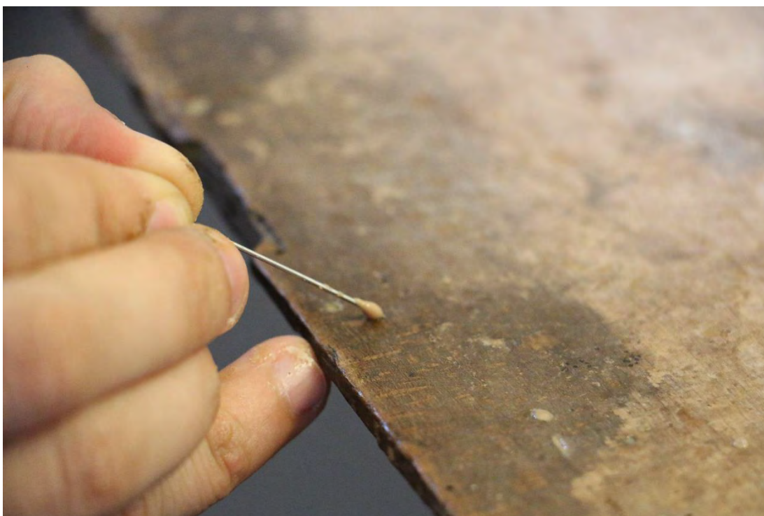
Obrázek 44 Tmelení dřevěné desky
