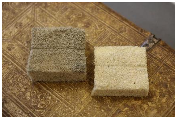
Obr. 221 Mechanické čištění suchou cestou (pryž Wallmaster)
