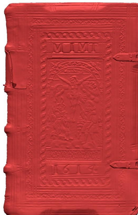
Obr. 186 3D skener – ATOS Compact Scan (useň s méně výraznou strukturou – teletina) – autor obrazu Jiří Kmošek
