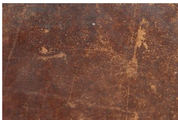
Obr. 210 Mechanické poškození (poškrábání)
