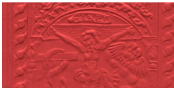
Obr. 188 Detail 3D skener – ATOS Compact Scan (useň s méně výraznou strukturou – teletina) – autor obrazu Jiří Kmošek
