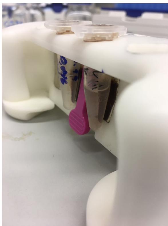
Obrázek 40 - Magnetický separátor k separaci magnetických částic během experimentu ve vsádkovém uspořádání
