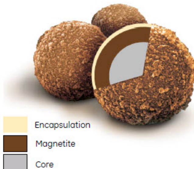
Obrázek 5 - Struktura magnetických částic SeraMag (obal, magnetická vrstva, jádro) [38]
