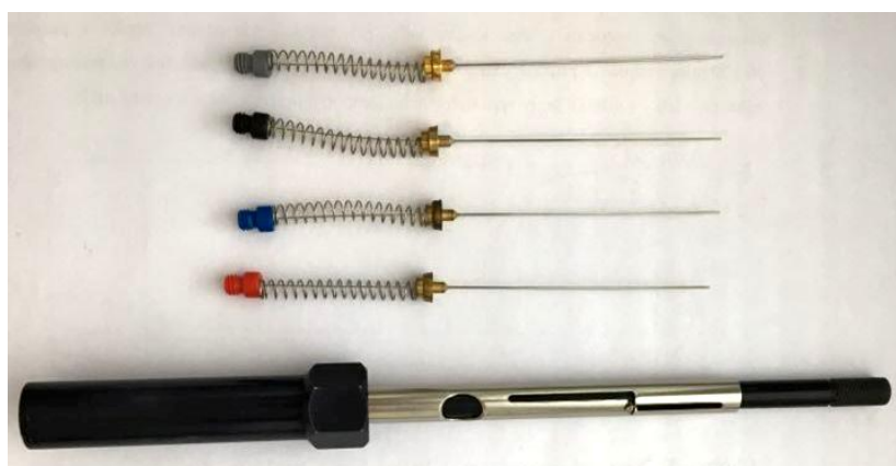
Obrázek 12: Vlákna a držák jehly pro metodu HS-SPME
