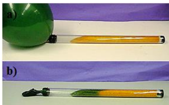
Obr. 12: Detekční trubička na alkohol. Před (a) a po (b) použití (převzato z [59]).
