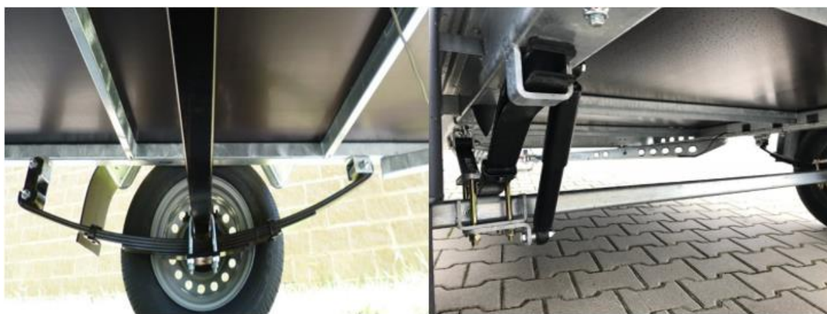
Obrázek 3 Odpružení pomocí listového pera [4] a [6]
