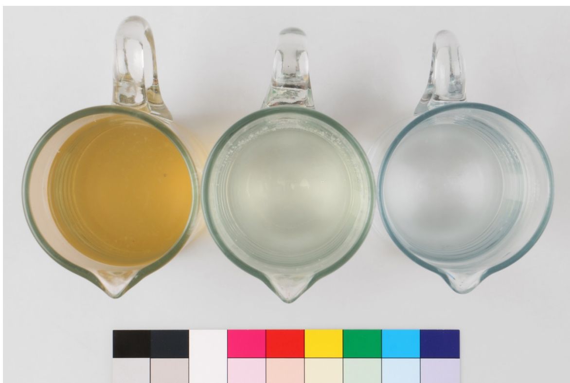
Obr. 40 Koncentrace vyplavených nečistot (první námok, výplach, čistá voda)
