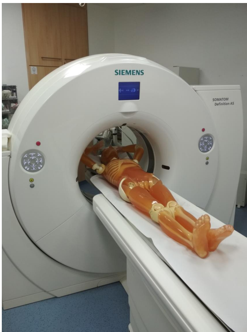
Obrázek 7 Antropomorfní fantom připravený k měření, fantom model PH-2 PBU-50 simulující pacienta. Jedná se o model člověka v životní velikosti, s umělou kostrou i vnitřními orgány (zdroj: foto autor).
