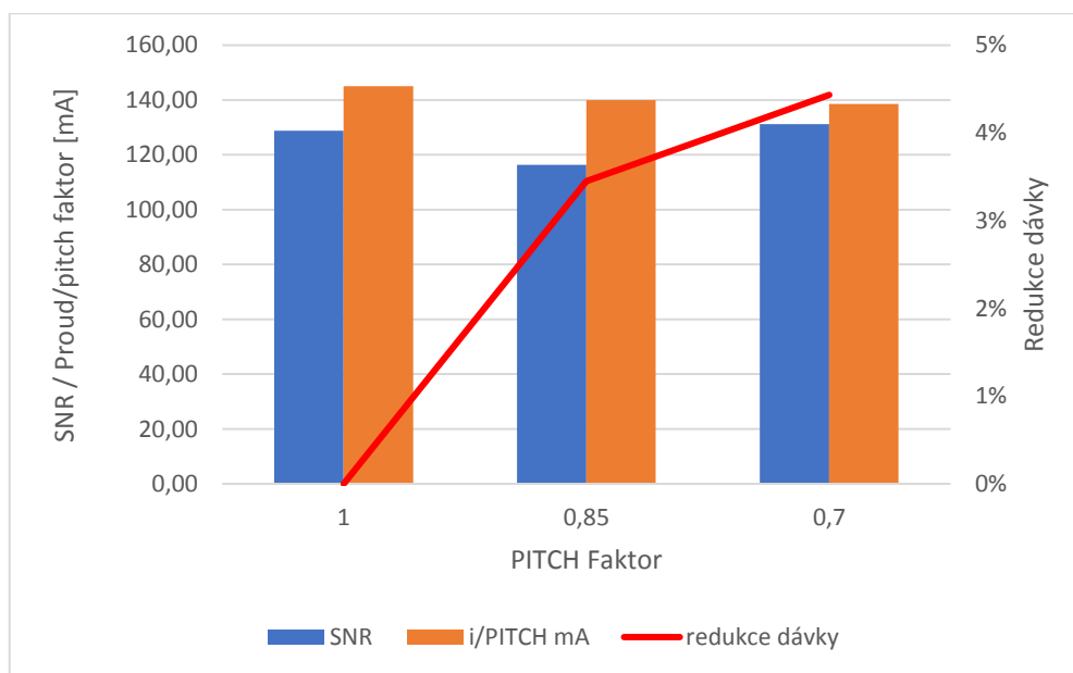
Obrázek 18 Graf - Možnost redukce zatížení pacienta IZ při CT vyšetření v oblasti jater změnou PITCH faktoru
