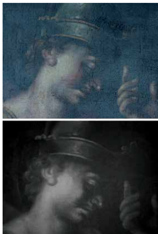
Obr. 4 Josef Cereghetti, Přijmutí kříže. Nahoře snímek UV luminiscence. Dole snímek v IR fotografii (Nikon D7000, IR filtr B+W IR-830). Fotografie © 2018 Fakulta restaurování
