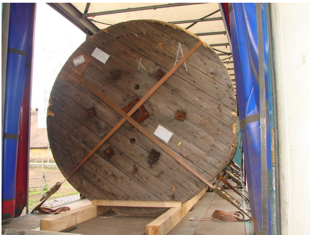
Obrázek 4: Naložená a zajištěná kabelová cívka
