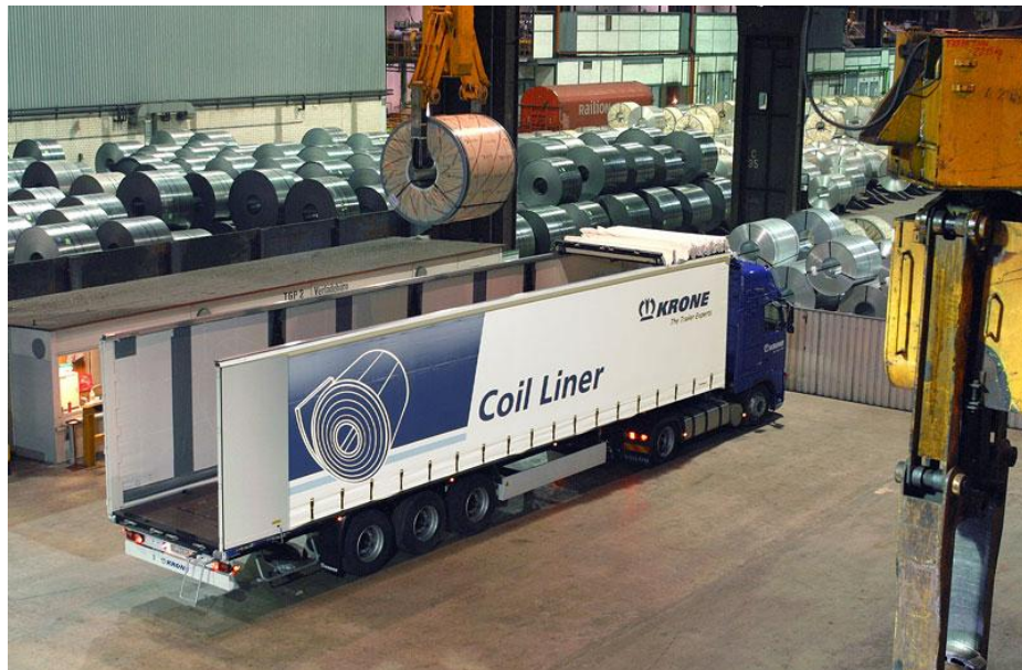
Obrázek 2: Typový příklad nakládky zboží seshora na návěsovou soupravu
