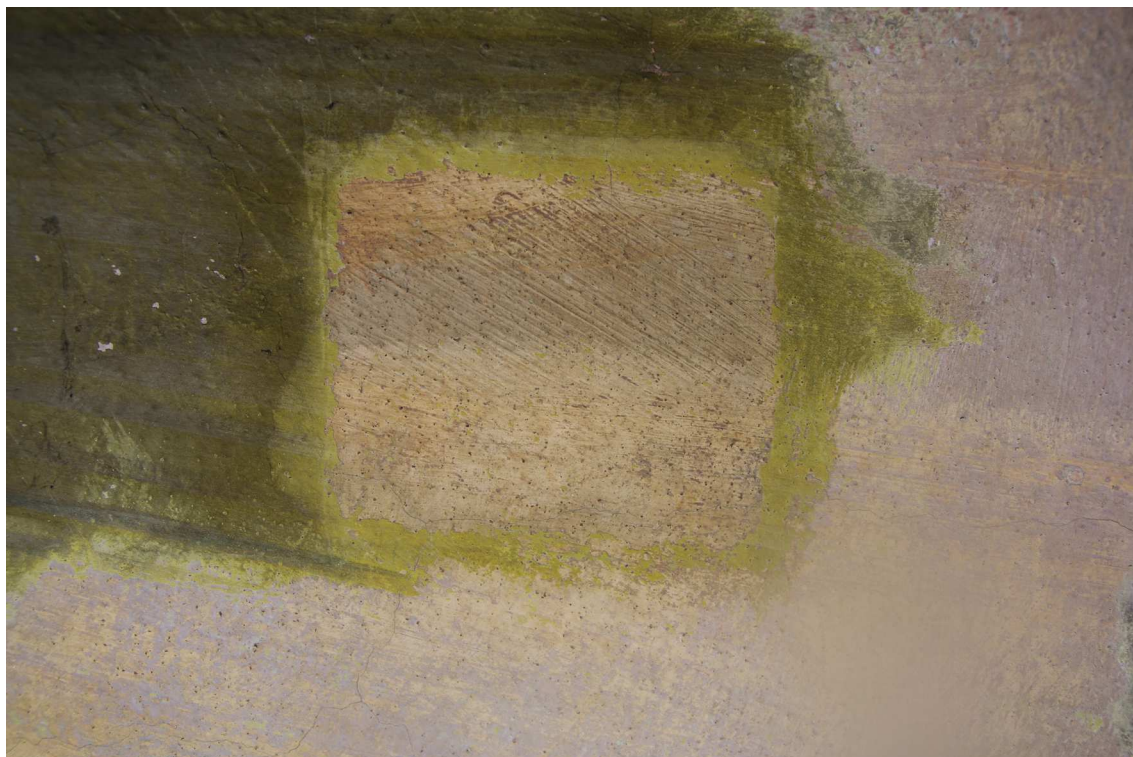
Obr. 32 Skúška odstránenia premaľby z 19. storočia iontomeničom Amberjet 4400 OH v zábale z buničiny v 15 minútovom pôsobení po dočistení vodou, kde pri tomto krátkom časovom intervale pôsobí iontomenič len na premaľbu a k poškodeniu barokovej farebnej vrstve nedochádza.
