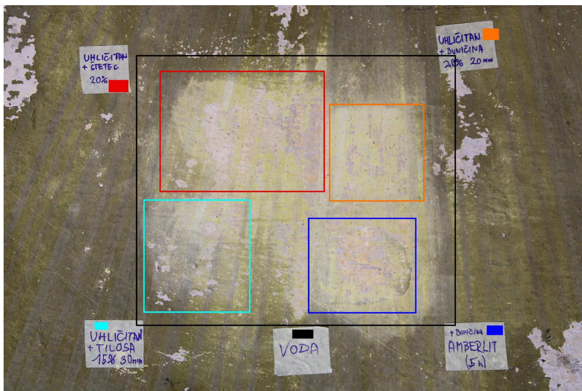
Obr. 34 Farebné zakreslenie použitých prostriedkov pre mokré čistenie a odstraňovanie premaľby z 19. storočia. Porovnanie rôznych metód odstraňovania premaľby. Pôsobenie iontomeniča (modré zakreslenie) v buničine a 5 hodinovom pôsobení spôsobil poškodenie v obidvoch farebných vrstvách.
