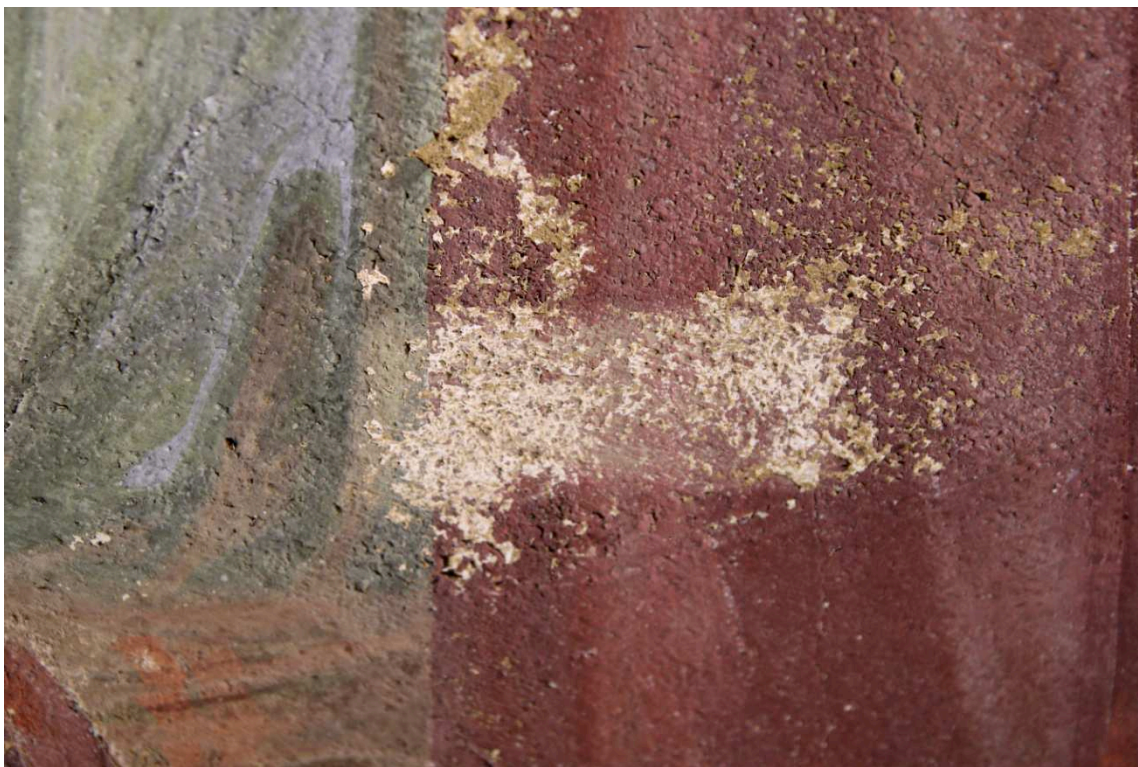
Obr. 27: Zkoušky odstraňování přemalby z 19. století suchými metodami v oblasti zpráškovatěné barevné vrstvy z 19. století.
