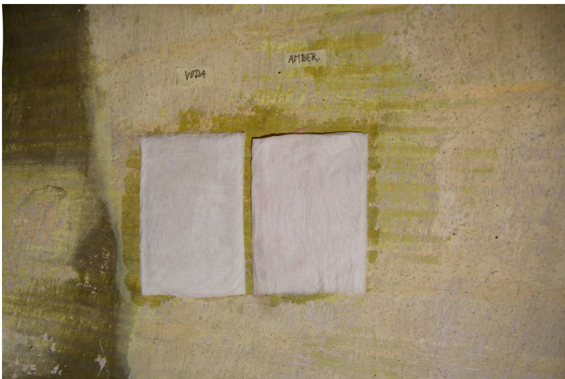
Obr. 32: Zkoušky odstranění přemalby z 19. století provedené lokálně na problémových těžko odstranitelných částí v oblasti nebe. Na fotografii jsou pozorovány zábaly v buničině s destilovanou vodou (vlevo) a anionaktivním iontoměničem Amberlit 4400 OH (vpravo). Byly aplikovány po dobu 10 minut. Detailní popis aplikace je popsán v kapitole 4.2 Zkoušky odstranění přemalby (vrstvy z 19. století).
