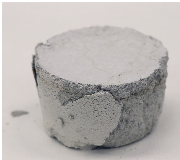
Obr. 106: T2LT pred vybrúsením. Vzorka z nenasiakavej formy.
