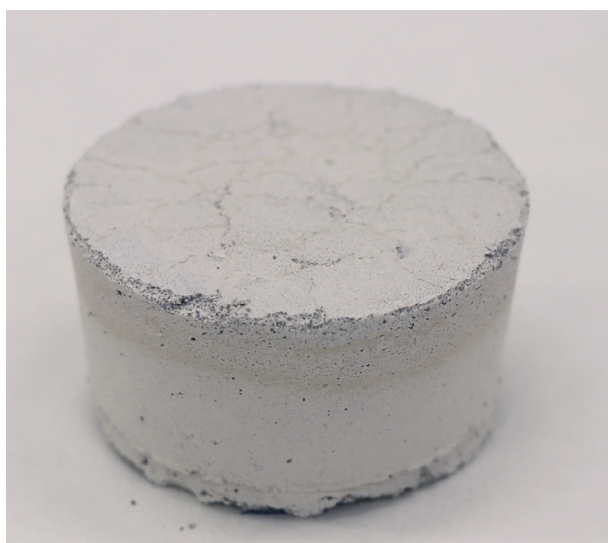
Obr. 94: T1L1 pred vybrúsením. Vzorka z nenasiakavej formy.
