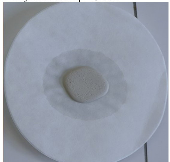
Obr. 87: T4CL - Test na retenciu vody čerstvou inj. maltou. Stav po 20. min.
