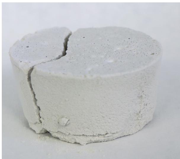
Obr. 120: T4CL pred vybrúsením. Vzorka z nenasiakavej formy.
