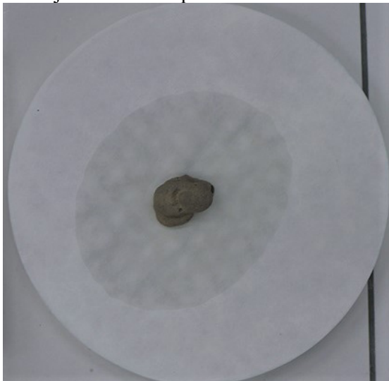
Obr. 79: T2LK9 - Test na retenciu vody čerstvou inj. maltou. Stav po 20. min.
