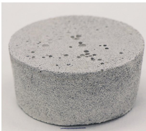
Obr. 101: T2L1 po vybrúsení. Vzorka z nenasiakavej formy.
