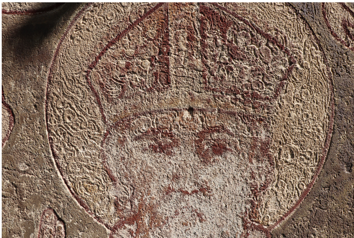
Obr. 23: Portrétna časť maľby sv. Vojtecha, v ostrom bočnom svetle pred reštaurovaním. Svetlo zvýraznilo degradáciu omietky v podobe drobných kružníc a špirál - tzv. alveolizácia. Zvýraznila sa tiež hranice medzi zlateným pozadím a maľbou svätožiare. Vynikol tiež stred kružnice, ktorá svätožiaru opisuje.
