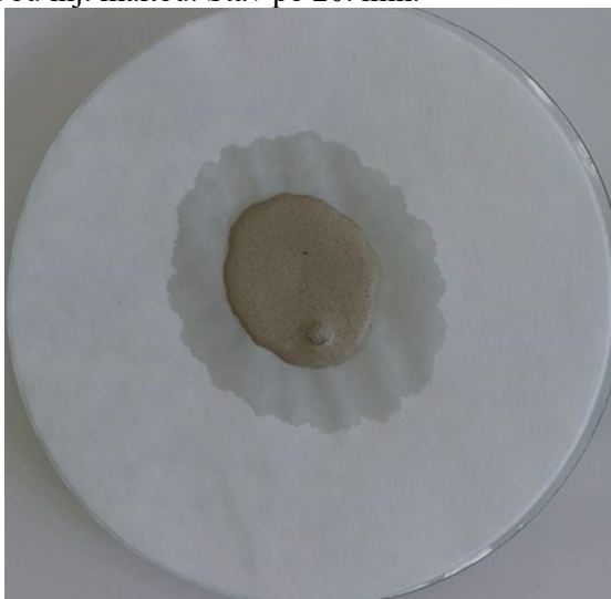
Obr. 81: T2P3 - Test na retenciu vody čerstvou inj. maltou. Stav po 20. min.
