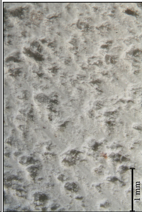
Štruktúra inj. malty po vytvrdnutí.
