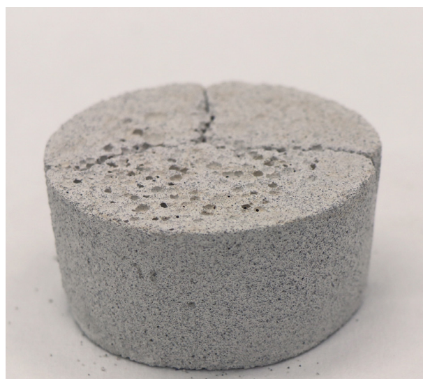
Obr. 103: T2L2 po vybrúsení. Vzorka z nenasiakavej formy.
