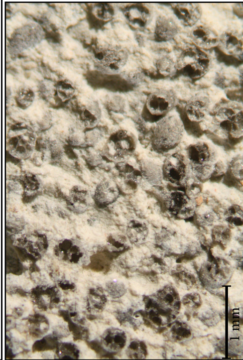
Štruktúra inj. malty po vytvrdnutí.
