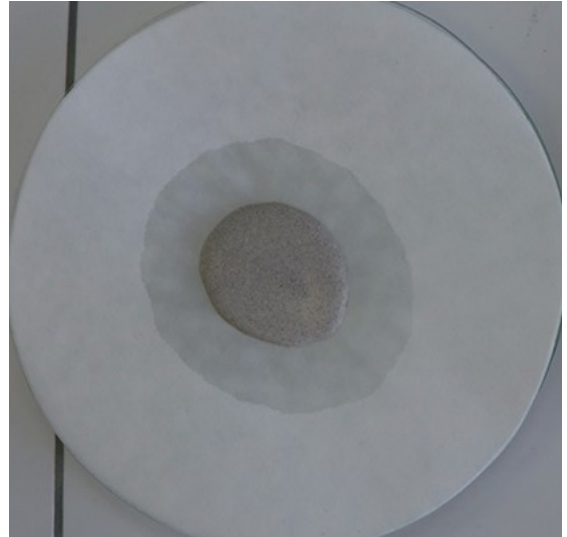
Obr. 83: T3LV - Test na retenciu vody čerstvou inj. maltou. Stav po 20. min.
