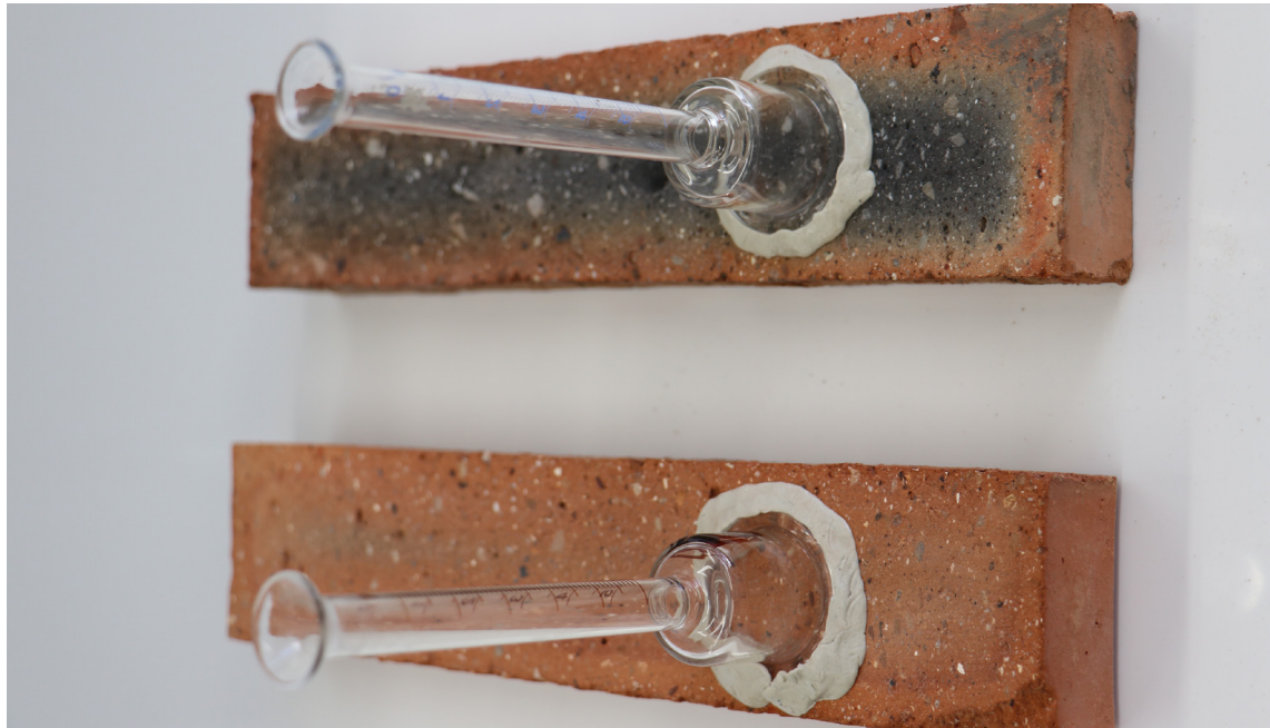
Obr. 122: Meranie nasiakavosti tehál . Tehly boli určené na test zatekania.
