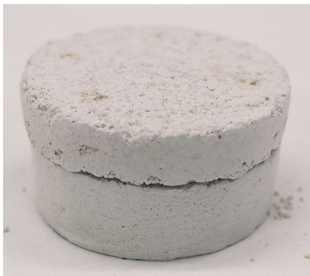
Obr. 99: T1P1 po vybrúsení. Vzorka z nenasiakavej formy.
