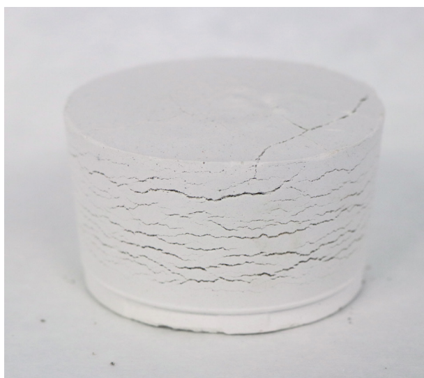
Obr. 118: T4LR pred vybrúsením. Vzorka z nenasiakavej formy.
