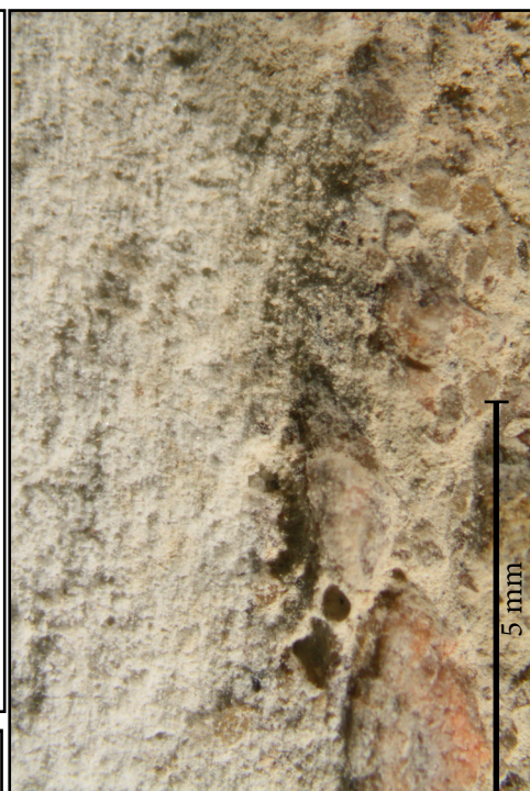
Detail rozhrania medzi inj. maltou a dnom formy.
