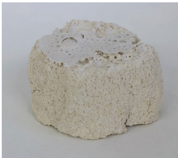
Obr. 112: T2P3 pred vybrúsením. Vzorka z nenasiakavej formy.
