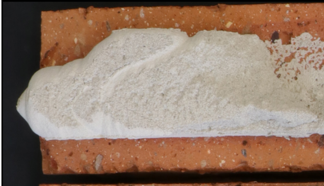
Detail vytvrdnutej inj. malty po rozlomení.
