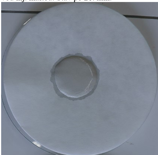
Obr. 86: T4LR - Test na retenciu vody čerstvou inj. maltou. Stav po 20. min.
