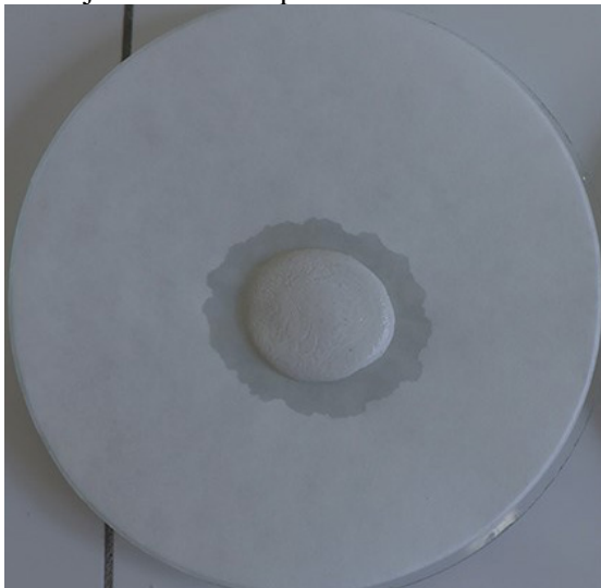
Obr. 84: T3PL - Test na retenciu vody čerstvou inj. maltou. Stav po 20. min.
