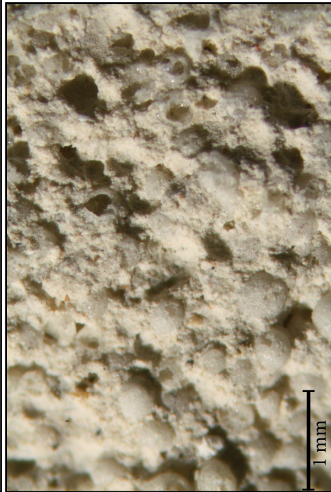
Štruktúra inj. malty po vytvrdnutí.
