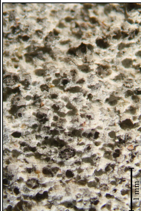
Štruktúra inj. malty po vytvrdnutí.
