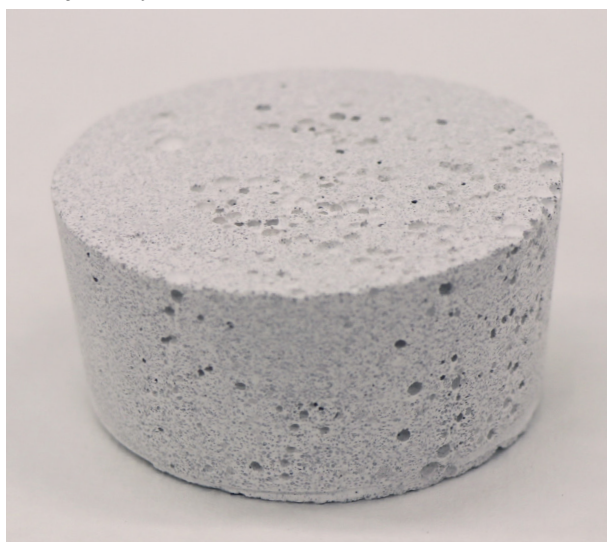
Obr. 109: T3LL po vybrúsení. Vzorka z nenasiakavej formy.
