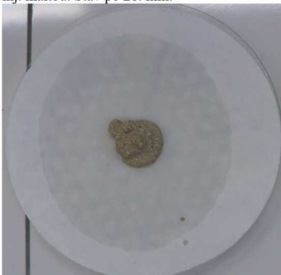
Obr. 76: T1P1 Test na retenciu vody čerstvou inj. maltou. Stav po 20. min.
