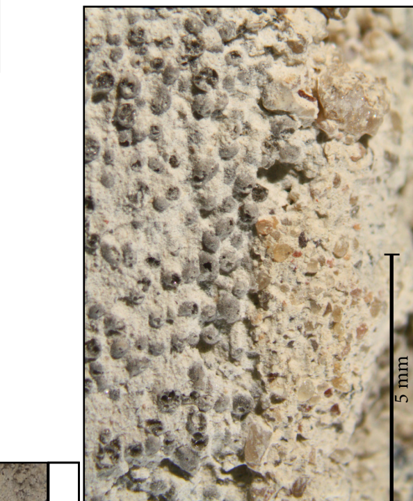
Detail rozhrania medzi inj. maltou a dnom formy.
