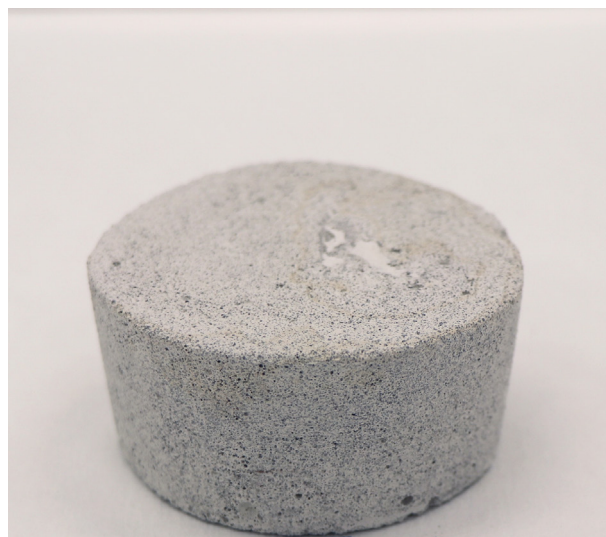
Obr. 105: T2LK9 po vybrúsení. Vzorka z nenasiakavej formy.
