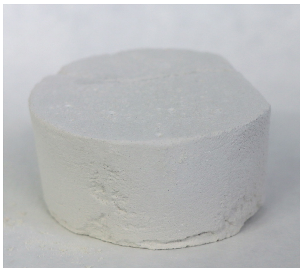
Obr. 121: T4CR po vybrúsení. Vzorka z nenasiakavej formy.
