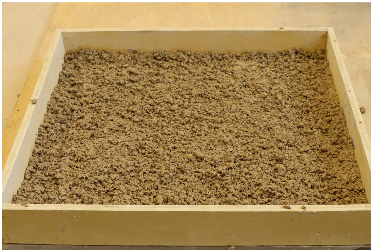
Obr. 88: Vrstva omietky na dne formy. Formovanie omietkových foriem.
