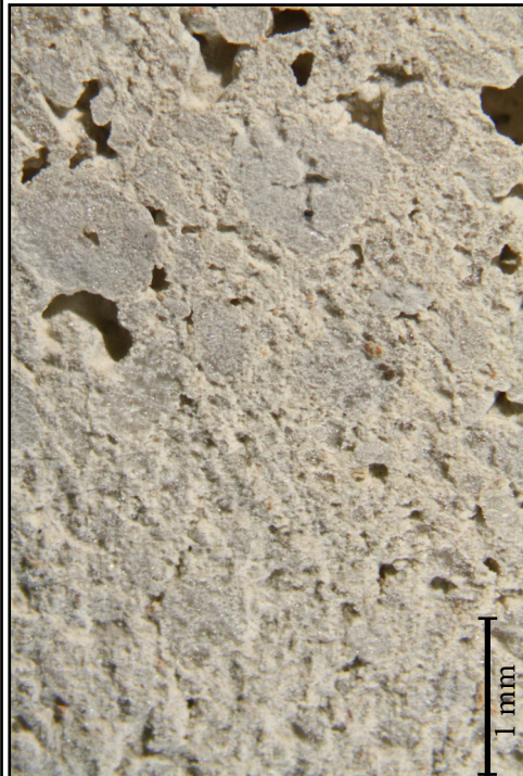
Štruktúra inj. malty po vytvrdnutí.
