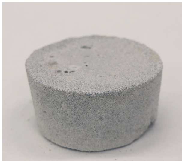
Obr. 107: T2LT po vybrúsení. Vzorka z nenasiakavej formy.
