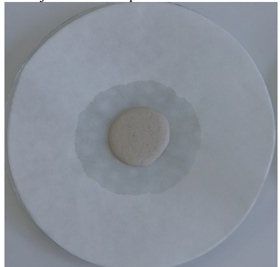
Obr. 85: T3PV - Test na retenciu vody čerstvou inj. maltou. Stav po 20. min.
