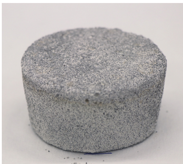
Obr. 95: T1L1 po vybrúsení. Vzorka z nenasiakavej formy.
