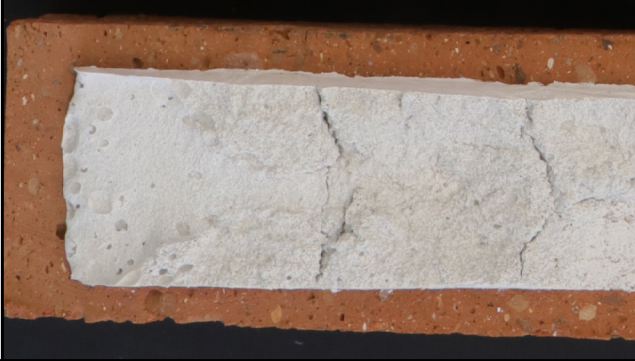
Detail vytvrdnutej inj. malty po rozlomení.
