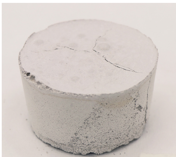
Obr. 102: T2L2 pred vybrúsením. Vzorka z nenasiakavej formy.
