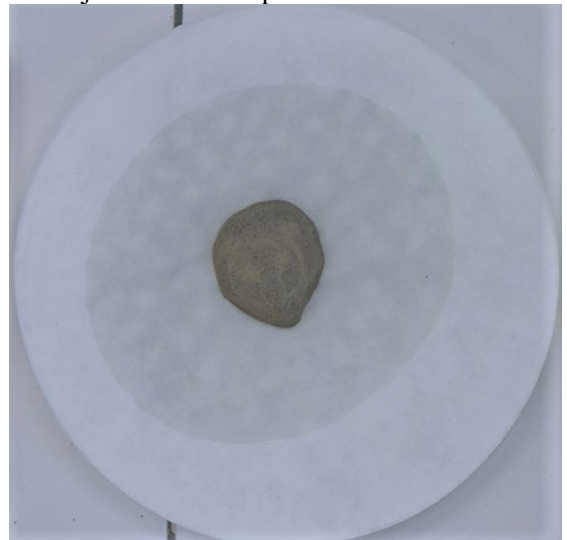
Obr. 75: T1L2 Test na retenciu vody čerstvou inj. maltou. Stav po 20. min.
