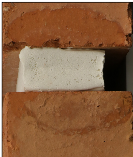
Detail hornej časti formy po vytvrnutí t2.
