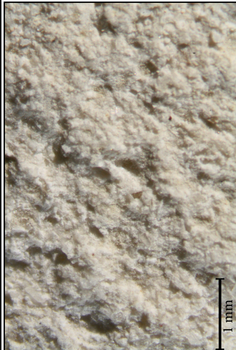
Štruktúra inj. malty po vytvrdnutí.
