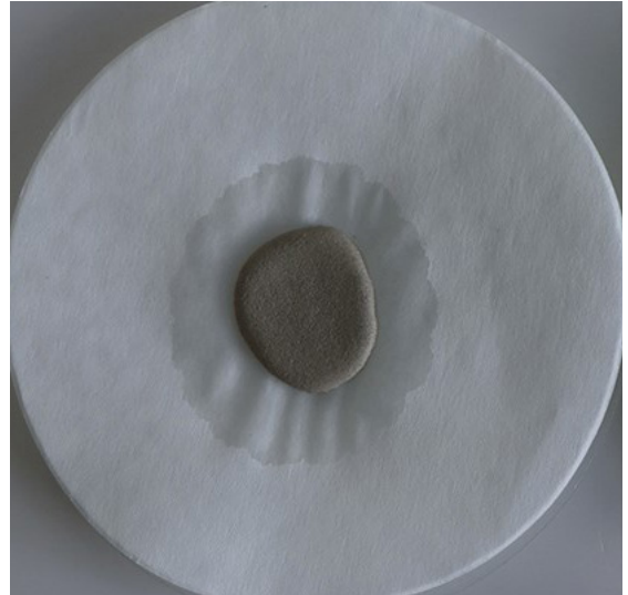
Obr. 78: T2L2 - Test na retenciu vody čerstvou inj. maltou. Stav po 20. min.
