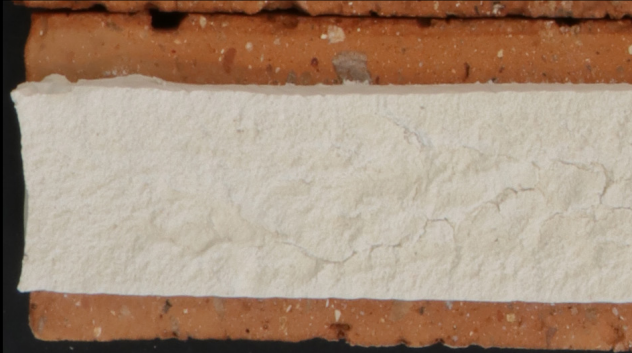
Detail vytvrnenej inj. malty po rozlomení.
