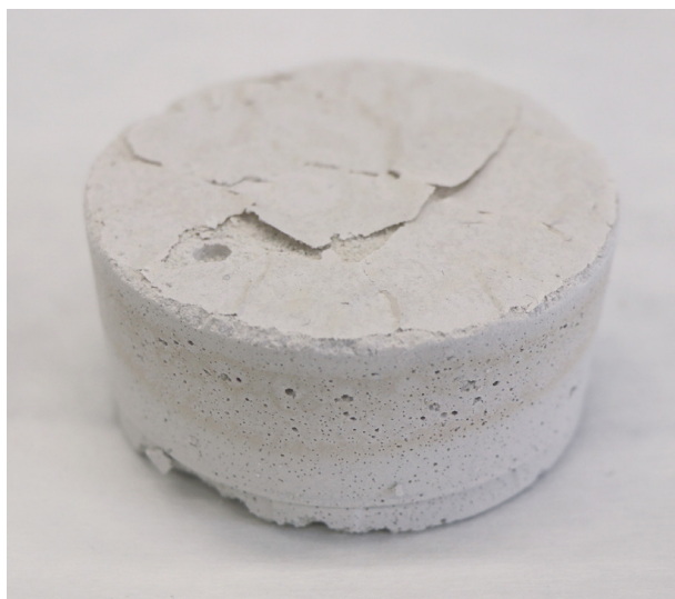
Obr. 92: T1Pr2 pred vybrúsením. Vzorka z nenasiakavej formy.
