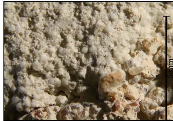
T1Detail rozhrania medzi inj. maltou bočnou stenou formy.
