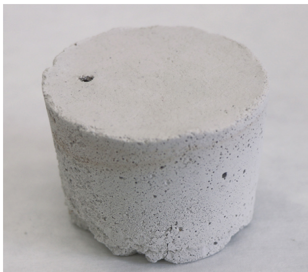
Obr. 90: T1Pr1 pred vybrúsením. Vzorka z nenasiakavej formy.
