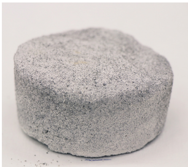
Obr. 97: T1L2 po vybrúsení. Vzorka z nenasiakavej formy.
