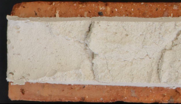
Detail vytvrdnutej inj. malty po rozlomení.
