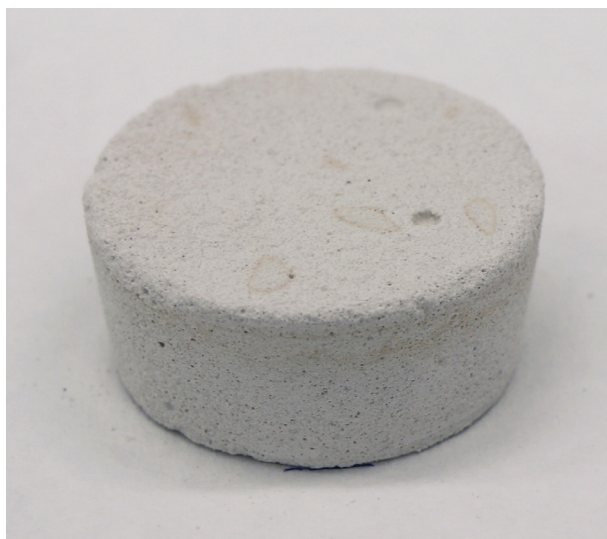
Obr. 93: T1Pr2 po vybrúsení. Vzorka z nenasiakavej formy.
