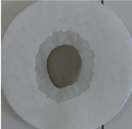
Obr. 77: T2L1 - Test na retenciu vody čerstvou inj. maltou. Stav po 20. min.
