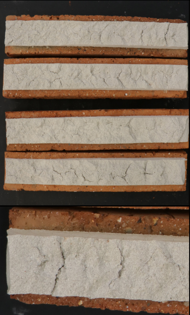
Detail vytvrdnutej inj. malty po rozlomení. Celkový pohľad po rozlomení.
