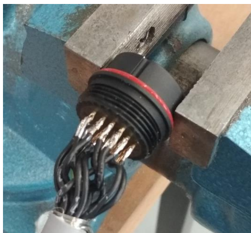
Obrázek 21 Připájený konektor ke kabelu
