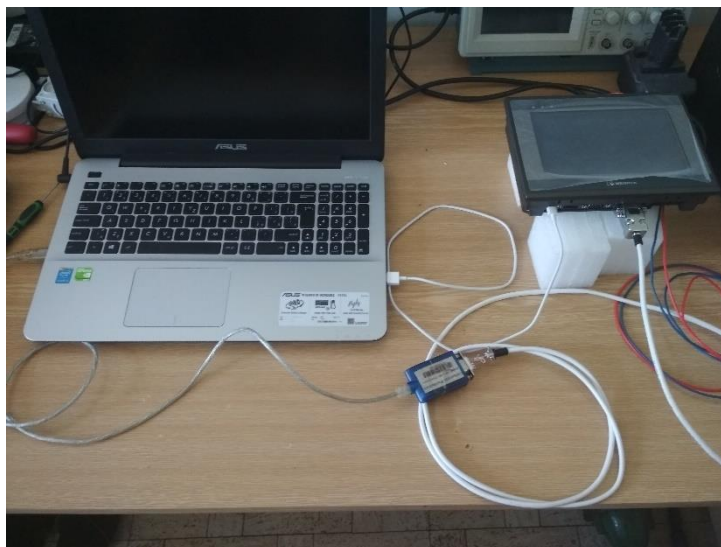
Obrázek 17 Zapojení CAN analyzátoru s redukcí při testování displeje
