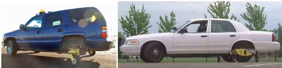
Obr. 4 Volné natáčení přídavných zadních kol [64]
