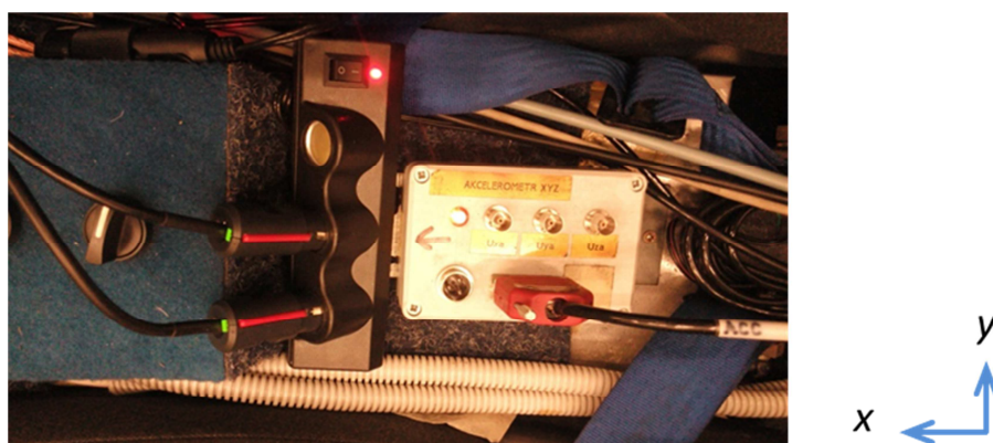
Obr. 36 Osazení vozidla pro měření příčného a podélného zrychlení
