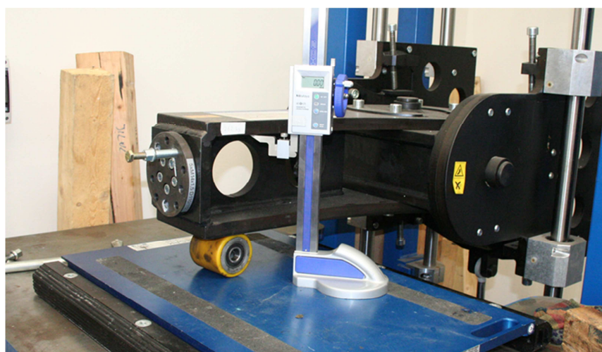
Obr. 23 Zjištění deformační charakteristiky kolečka kolové jednotky na statickém adhezoru
