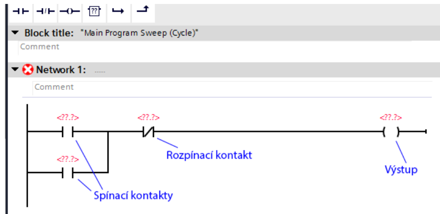
Obr. 3.8 – Struktura programu pro ovládání motoru
