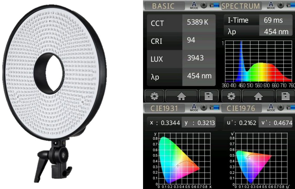
Obrázek 13: Kruhový zdroj světla DVR-630DVC (vlevo) a jeho podání barev (vpravo) [34]
