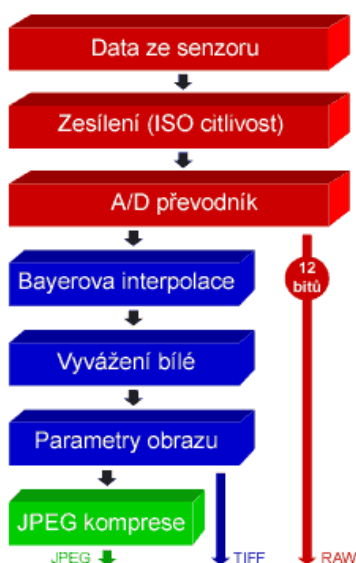
Obrázek 7: Schéma zpracování obrazových dat při vzniku digitální fotografie [15]
