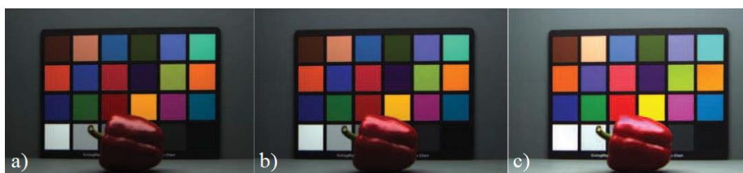
Obrázek 11: Problém změny osvětlení při polynomiální transformaci 4. stupně [1]
