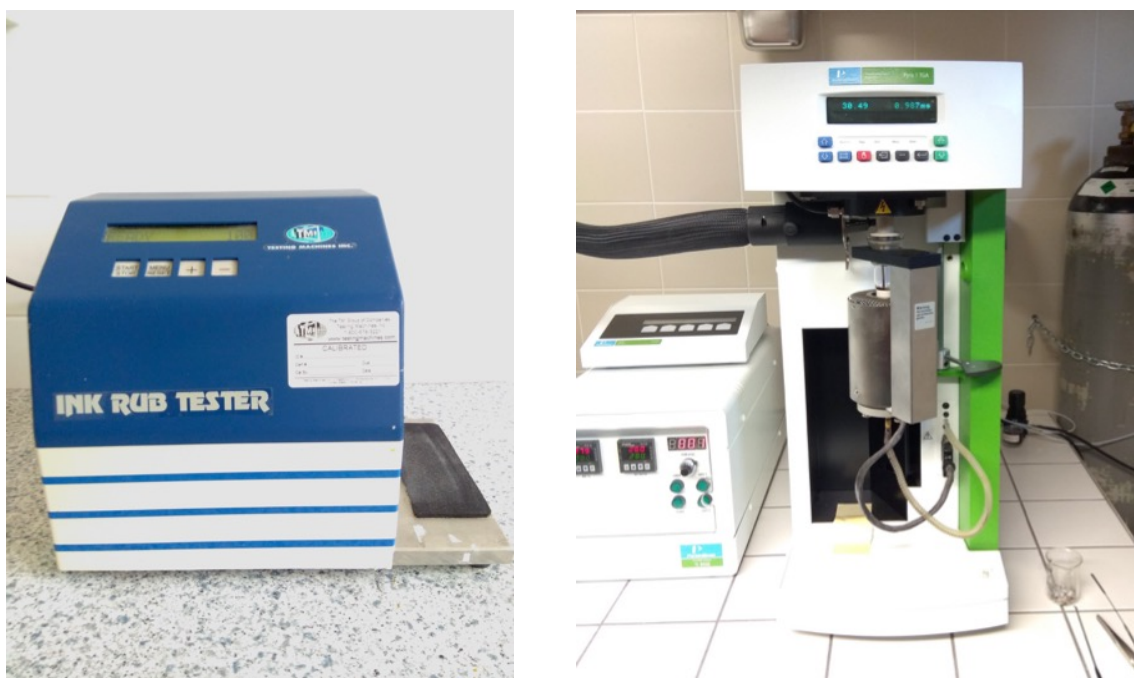
Obr. 14 – Přístroj pro otěr Ink Rub Tester (vlevo) a přístroj pro termogravimetrickou analýzu Pyris 1 TGA HT (vpravo)
