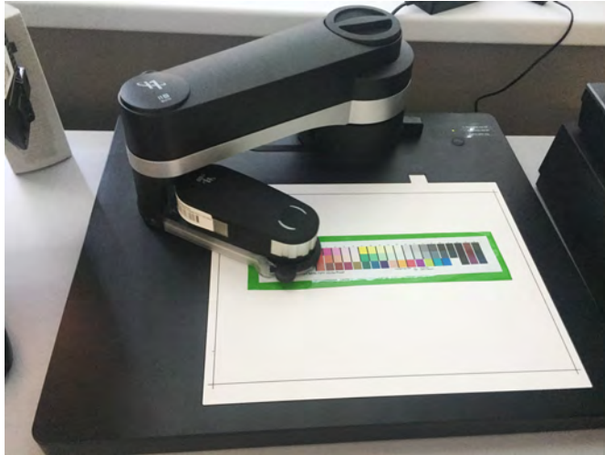
Obr. 25 Samotné měření vzorníku probíhá zcela automaticky a je nesmírně rychlé a efektivní
