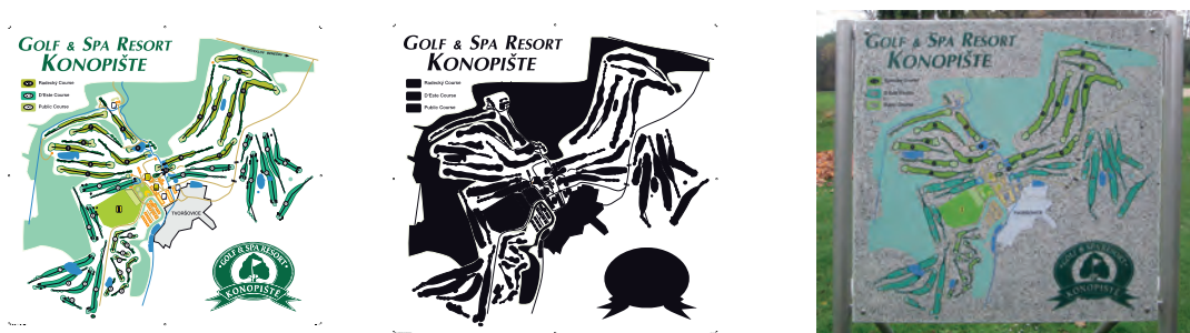
Obr. 26 Data od zákazníka v pdf včetně připraveného bílého podtisku a výsledek v praxi
