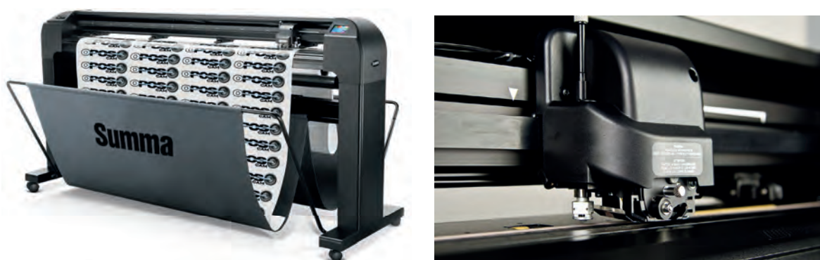
Obr. 7 Plotr a detail řezací hlavy s integrovanou OPOS kamerou [21]
