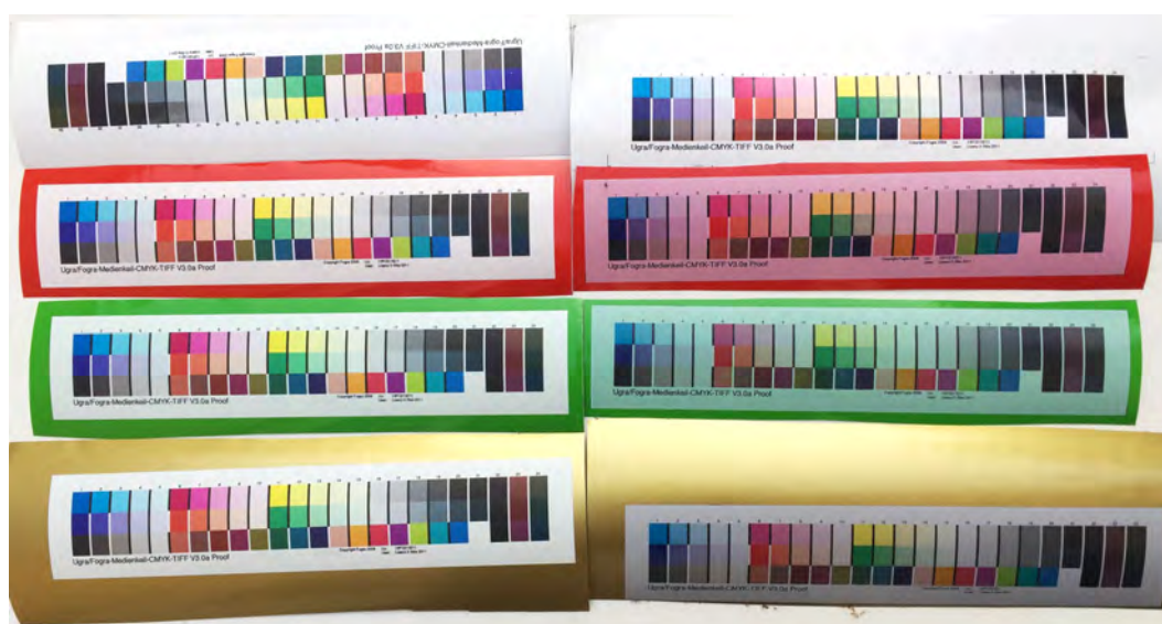
Obr. 24 Vytištěné vzorky na bílých a barevných fólii, vlevo na UV, vpravo na Latexu. Již na první pohled se potvrdil závěr tohoto testu.
